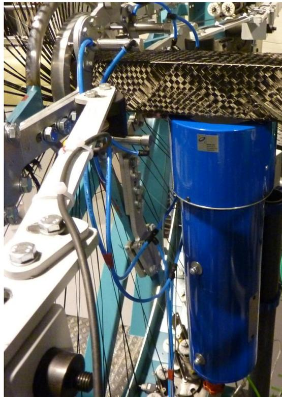
Abb. 2.35: Sensorkopf am UD-Flechter montiert
