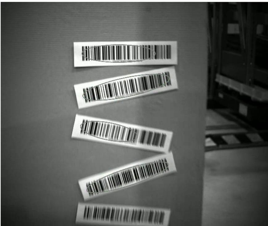
**Abbildung 6-15: Schattenwurf bei ausschließlich künstlicher Deckenbeleuchtung**
