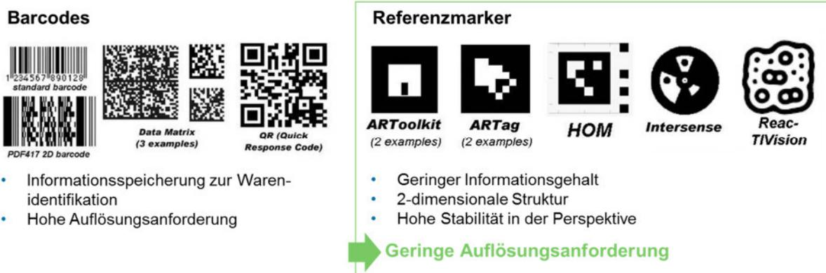
Abbildung 5-11: Beispiele für Barcodes und Referenzmarker
