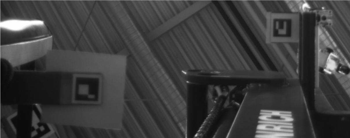
Abbildung 5-17: FOV mit Hubhöhenmarker (rechts) und Neigungsmarker (links)
