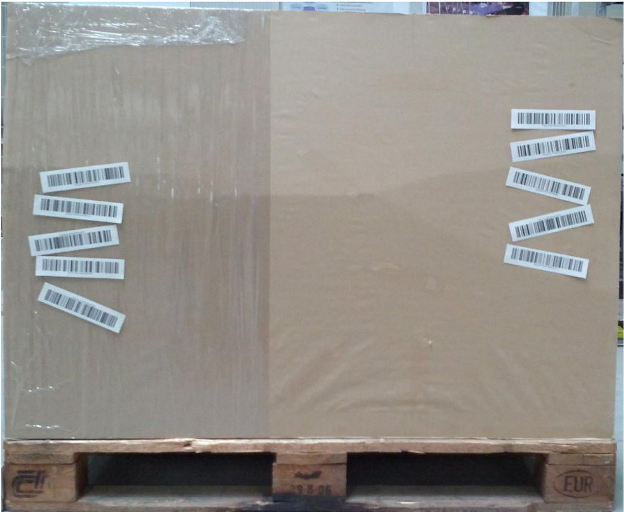
**Abbildung 6-13: Testfläche mit 10 NVE-Barcodes in unterschiedlicher Orientierung**
