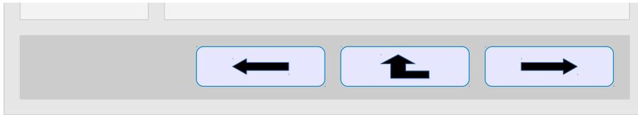
**Abbildung 5.8: Navigationsmenü der Montageablaufplan-GUI** - Diese Abbildung zeigt drei Schaltflächen zur Navigation durch den Montageablaufplan (von links nach rechts): *letzter Schritt*, *Zurück* und *nächster Schritt*.
