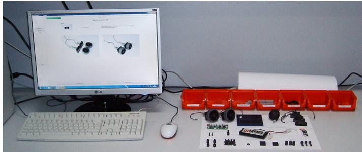
**Abbildung 5.13: Versuchsaufbau zur Montageablaufplan-GUI** - An diesem Arbeitsplatz wurde die Montageablaufplan-GUI evaluiert [92]. Links ist der Monitor zu sehen, der die GUI anzeigt. Die Interaktion mit der GUI erfolgt mittels Maus und Tastatur. Rechts neben dem Monitor sind die Bauteile gelagert.
