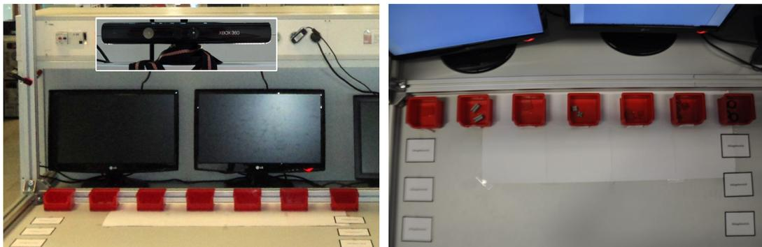
**Abbildung 4.1: Arbeitsstation überwacht mit Microsoft Kinect** - Die dargestellte Arbeitsstation wird von oben mit einer Tiefenbildkamera überwacht (siehe weiß hinterlegtes Rechteck links). Die Montage des Produkts erfolgt im Arbeitsbereich des Werkers. Die Szenenansicht der Kinect ist rechts abgebildet. Abbildung in Anlehnung an [89].
