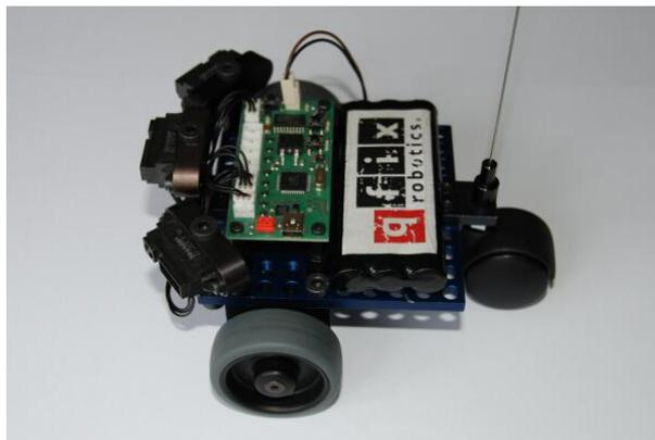
**Abbildung 4.18: Crash-Bobby nach Arbeitsvorgang 8** - Die Abbildung zeigt den fertig gestellten Crash-Bobby nach ausgeführtem Arbeitsvorgang 8 [91].
