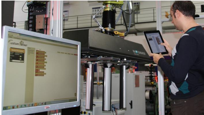
**Abbildung 2.8: CustomPacker Versuchsaufbau** - Diese Abbildung zeigt einen Werker, der einen Arbeitsablauf programmiert. Der Werker verwendet in diesem Beispiel ein Tablet, um seine Nutzereingaben zu tätigen.
