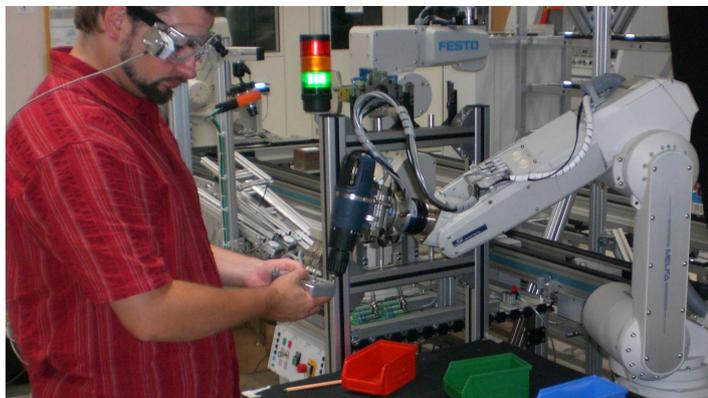
**Abbildung 2.7: JAHIR Versuchsaufbau** - Diese Abbildung zeigt eine Momentaufnahme eines gemeinsamen Arbeitsschritts von Werker und Industrieroboter. Der Werker wird in diesem Beispiel bei seiner Schraub-Aufgabe vom Industrieroboter durch Halten des elektrischen Bohrschraubers unterstützt.
