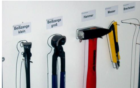
**Abbildung 5.21: Belegung einer Werkzeugwand** - In dieser Abbildung ist die Belegung einer Werkzeugwand an einem Schattenarbeitsplatz als Grundlage für das Design zur Context-Bubble zu sehen. Im Hintergrund befinden sich die passenden Konturzeichnungen zu den zugeordneten Werkzeugen. Eigenes Foto aufgenommen bei Transtechnik Bahntechnik (Büchlberg, Bayern, Deutschland).
