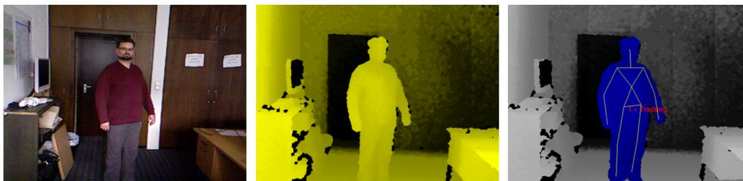
**Abbildung 4.4: Kinect-Aufnahme überlagert mit Drahtmodell** - Links ist das Farbbild einer Aufnahme eines Menschen zu sehen. In der Mitte ist das Tiefenbild der betrachteten Szene dargestellt. Rechts ist die Überlagerung beider Bilder zu sehen: das Drahtmodell im Tiefenbild der Kinect.
