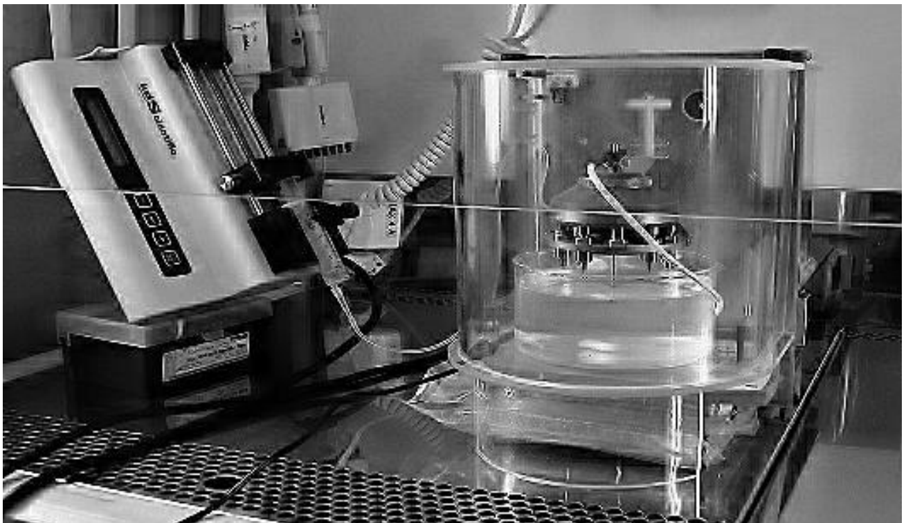
Abbildung 9: Zeigt den Bead-Generator unter der Reinbank: links im Bild der Spritzenperfusor mit Spritze, die über einen Schlauch mit dem Generator verbunden ist. Rechts der Generator mit Multi-Needle-Head von welchem aus die Beads durch die Needles in die unterhalb stehende Glasschale gepresst werden.
