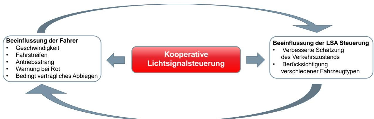
**Bild 1.1** Beeinflussungsmöglichkeiten durch kooperative Lichtsignalsteuerungen aus SANTA ET AL. [2014]
