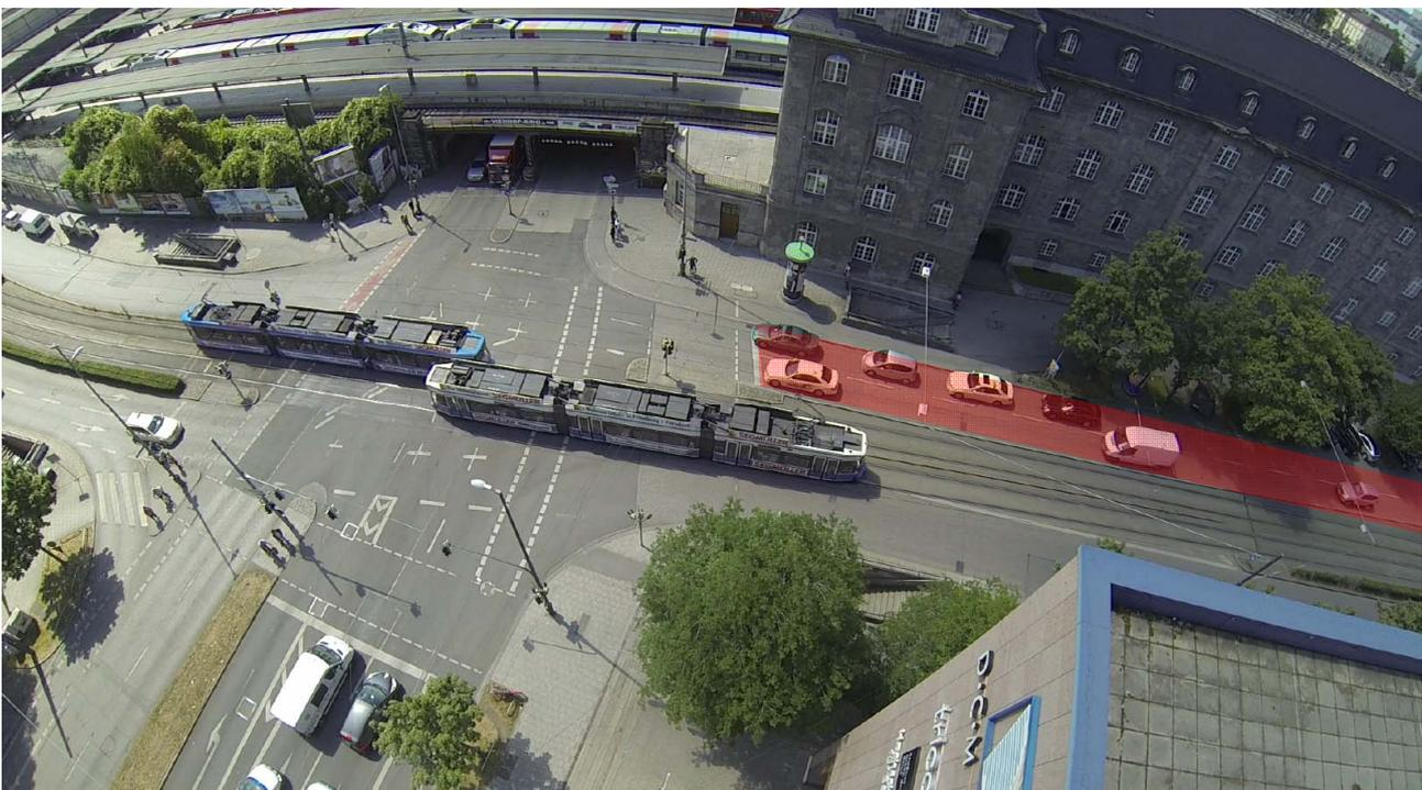
**Bild 7.4** Videobild Knotenpunkt Arnulfstraße, Seidlstraße in München. Die beiden Fahrstreifen, an denen die Staulänge geschätzt wird, sind hier rot markiert.
