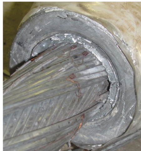
unterer Seilkopf (zylindrische Vergusshülse)
