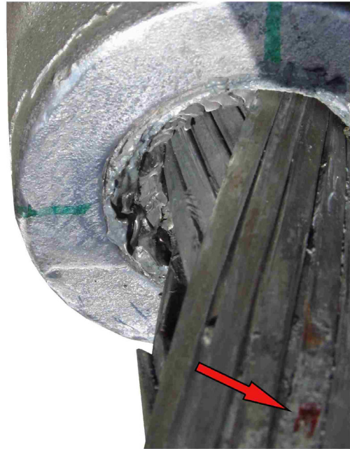
Herausziehen von Drähten der äußeren Z-Drahtlage beim Zerreißversuch (markierter DMS war ursprünglich am Seilaustritt)
