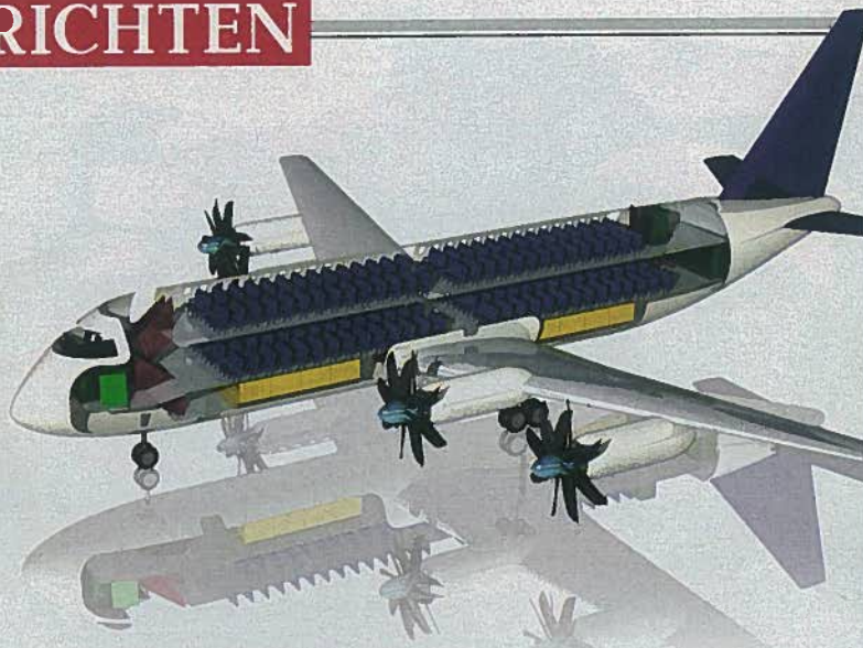
Auf zwei Stockwerken finden laut Entwurf 420 Passagiere Platz in der Propellermaschine
