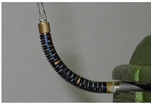
(a) Aktuierter Manipulator aus NiTi-Legierung
