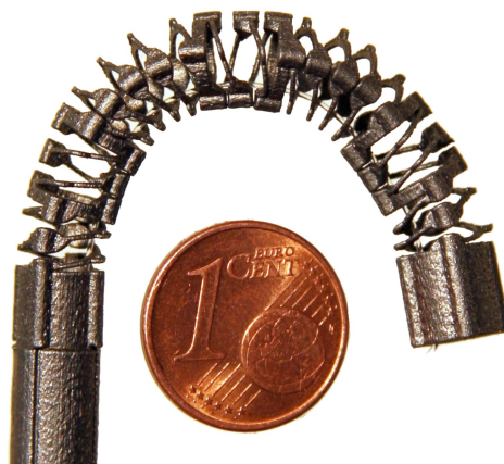
Abbildung 10.13: Gefertigter Prototyp aus Werkzeugstahl
