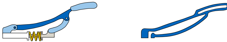
(a) Mechanismus, bestehend aus sieben Einzelteilen
