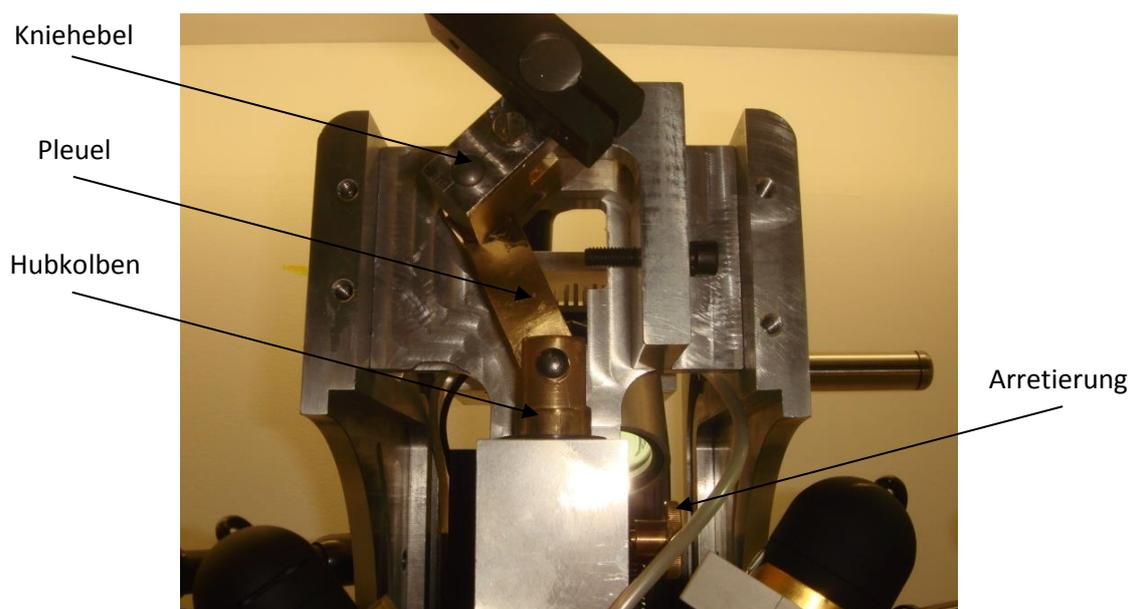
Abb. 38: Umgesetzte Kinematik des Greif- / Absetzwerkzeuges in Form eines zentrischen Schubkurbelgetriebes.
