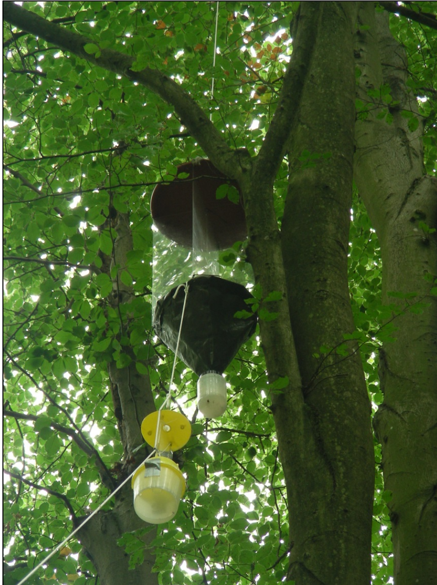
Abb. 5. Darstellung der verwendeten Fallensysteme im Kronenraum; oben: Kreuzfensterfalle, Prallfläche: zwei gekreuzte Plexiglasscheiben, 40 x 60 cm; unten: gelber bioform Mini-Ekilektor ® : Prallfläche: eine Plexiglasscheibe, 28 x 16 cm
