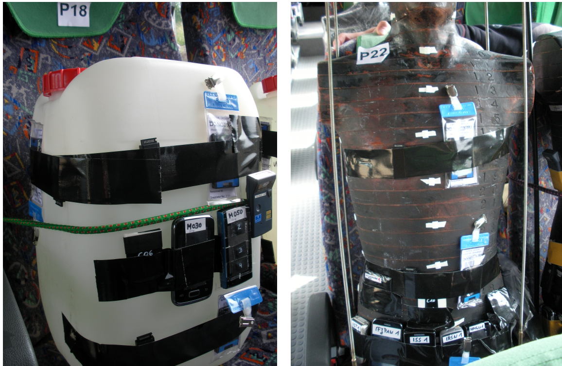
Abbildung 6.2.5: Notfalldosimeter und Referenzdosimeter, wie elektronische Personendosimeter, TL- und OSL-Dosimeter fixiert an unterschiedlichen Positionen am Wasserkanister (links) und am anthropomorphen Phantom (rechts).
