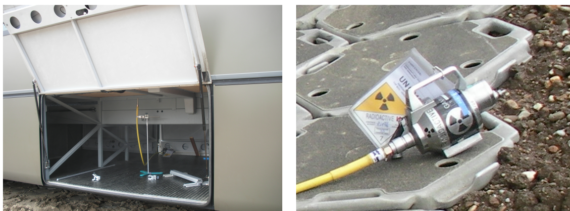
Abbildung 6.2.3: Fixierung des Endschlauchs der Quelle im Gepäckraum des Busses (links) und Behälter mit Kennzeichnung der eingesetzten Ir-192 Quelle (rechts).
