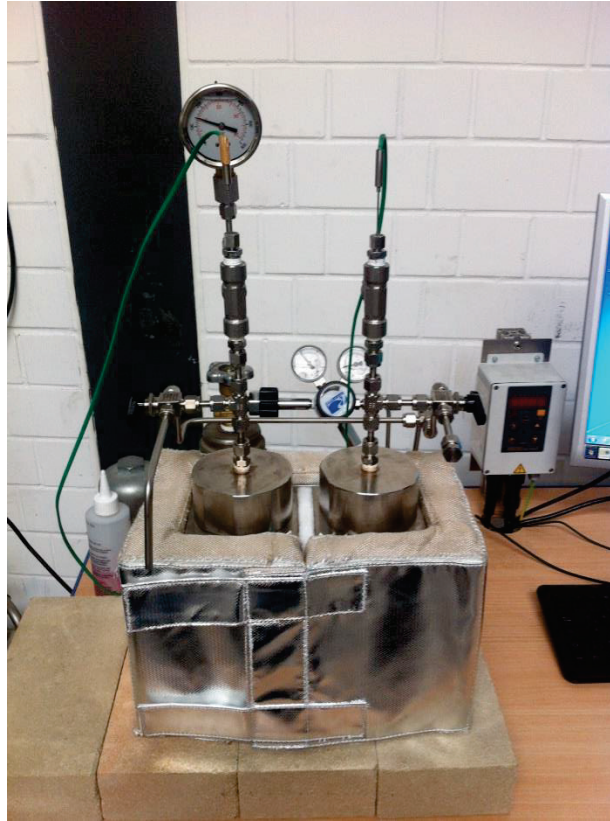
Abbildung 4.1: Aktueller Aufbau der Versuchsanlage zur Differentiellen Temperaturanalyse
