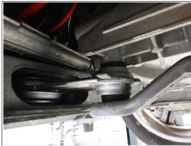
Abbildung 6.2: Drehmomentstütze zur Aufnahme der Drehmomente
