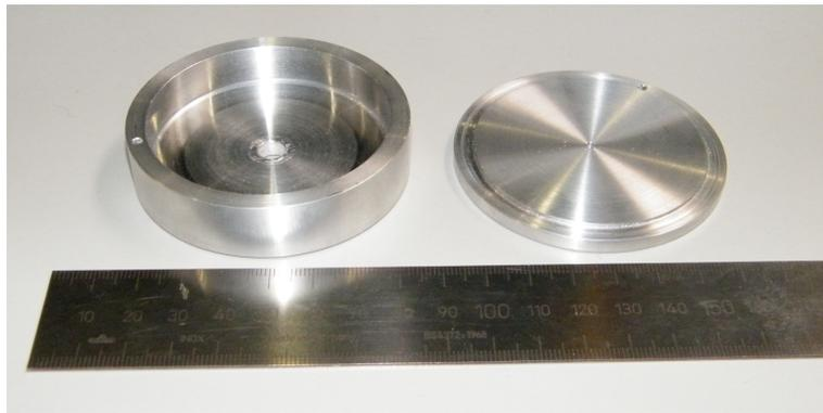
Abbildung 8.19.: Aluminiumdose als Partikeldämpfer. Der Dämpfer kann an verschiedenen Stellen des Panels angebracht werden.
