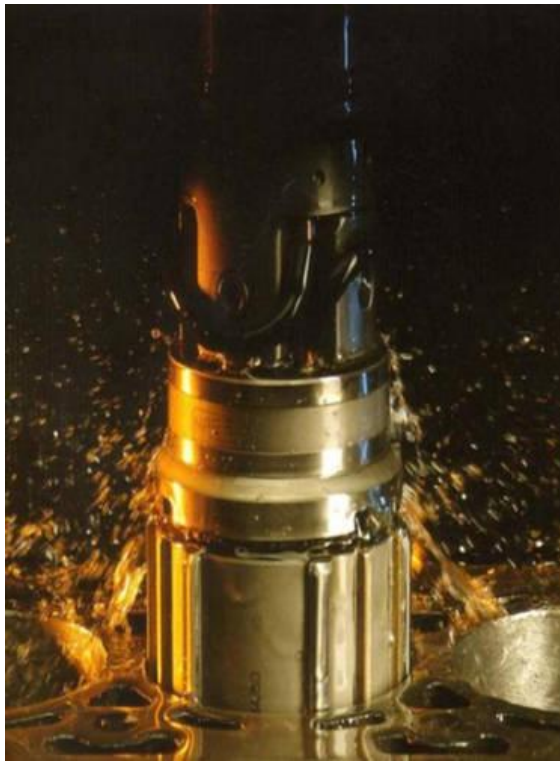
Abbildung 2-13: Honwerkzeug [66] und schematischer Honprozess (rechts)
