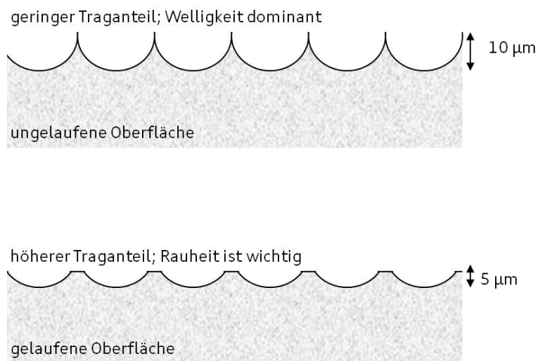
Abbildung 2-6: Rauheit und Welligkeit auf dem Kolbenschaft
