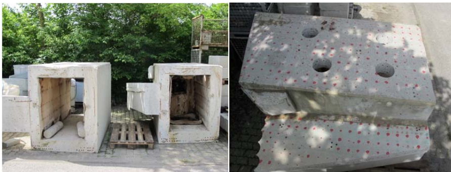
Bild 6-3: Die Randbalkensegmente auf dem cbm-Außenlager.
