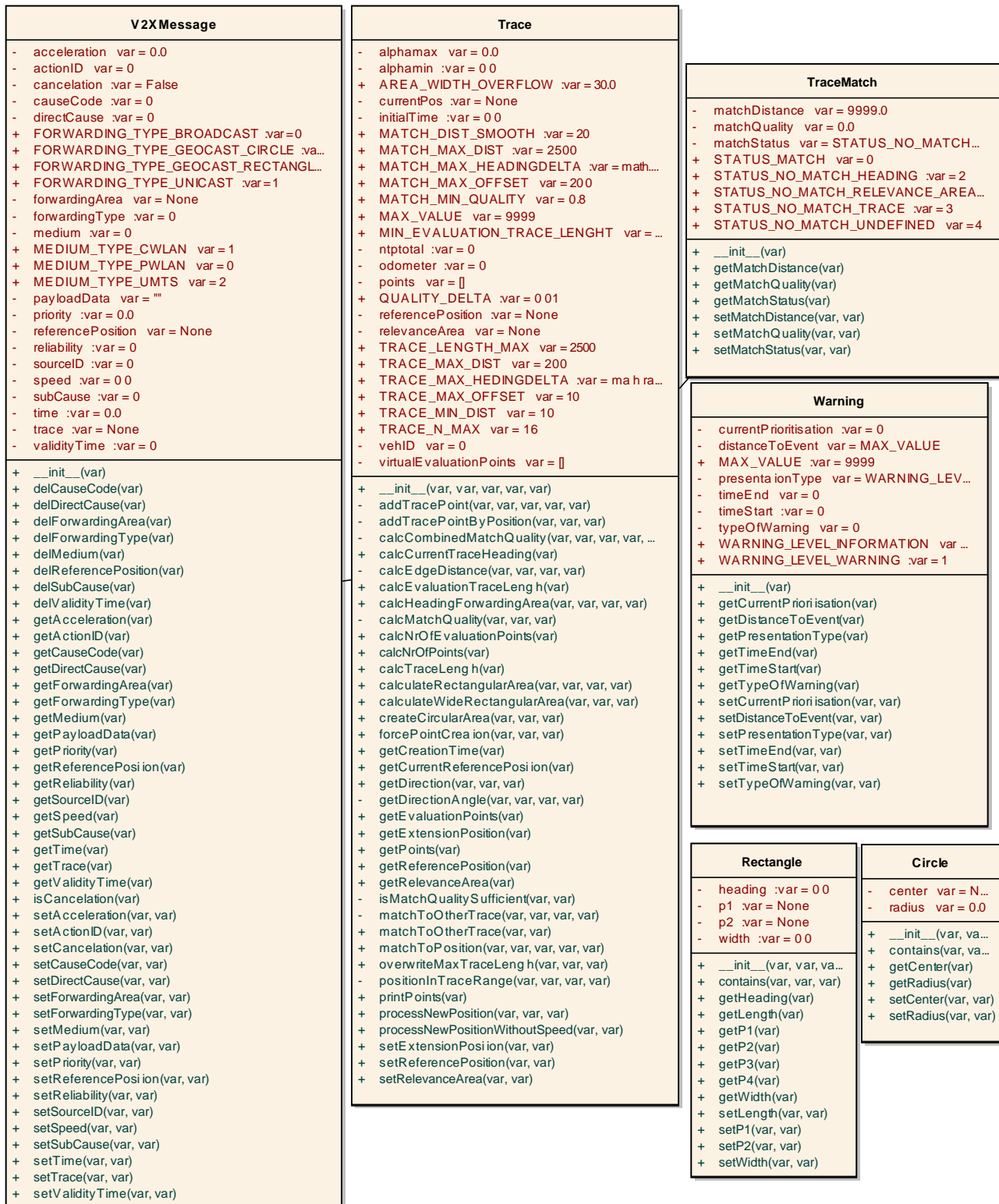
Bild A.2 UML-Klassendiagramm der erweiterten Klassen in der Application-Komponente zur Implementierung von IVS-Anwendungsmodellen.
