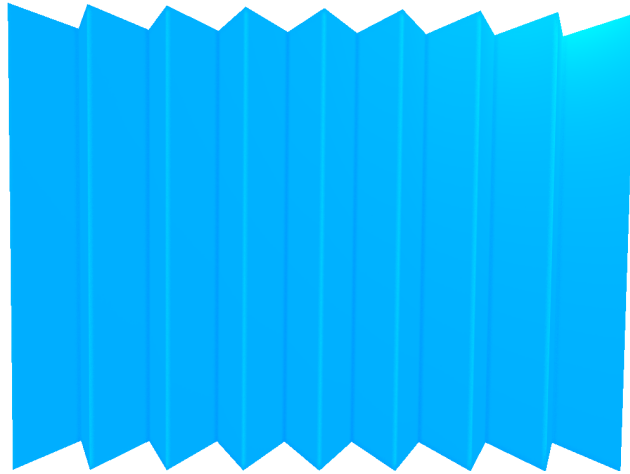
Abbildung 6.7.: An Kanten ist ein größerer Raumwinkel der Atmosphäre sichtbar, daher steigt die Temperatur schneller an. An Vertiefungen ist dieser Effekt umgekehrt.
