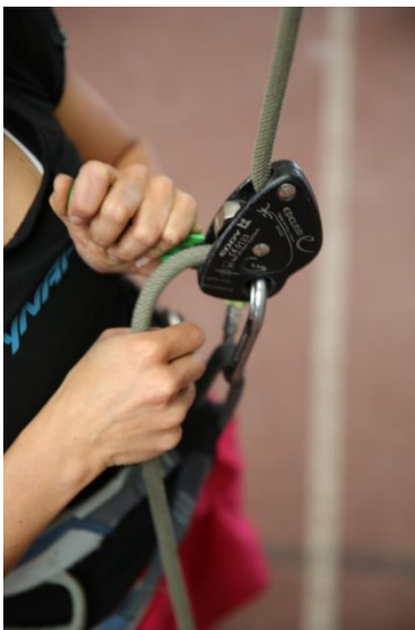
Abbildung 9 Sicherungsgerät „Eddy“ in der Anwendung Links: Handhabung des Sicherungsgerätes. Rechts: Hochsteigen eines Therapeuten zur Begleitung eines Patienten in der Wand (Archiv Kern)
