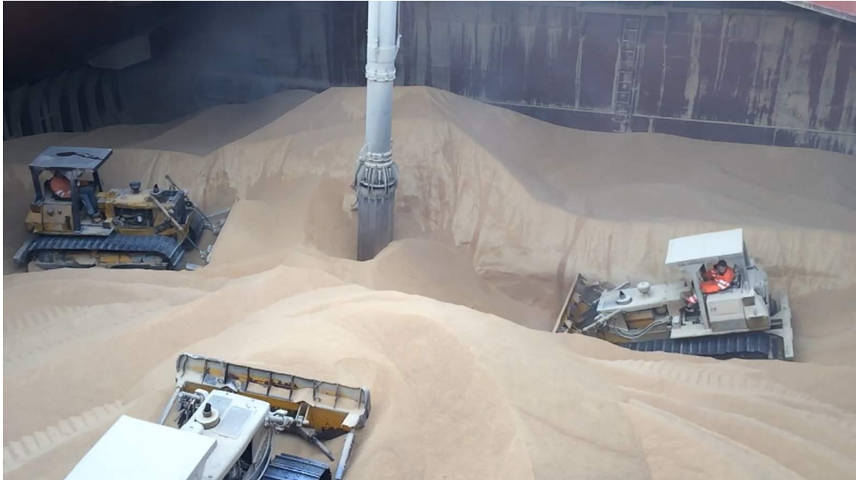
Abbildung 1-2: Planierraupen unterstützen während der Hauptentladung
