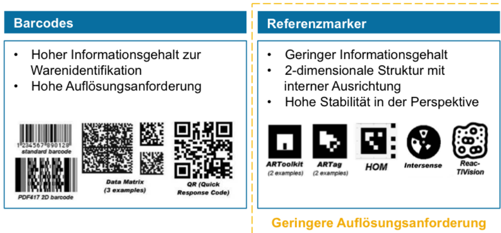
Abbildung 6-3: Übersicht zu künstlichen Merkmalen in Form von Barcodes u. Referenzmarkern (nach [FIA-2010])
