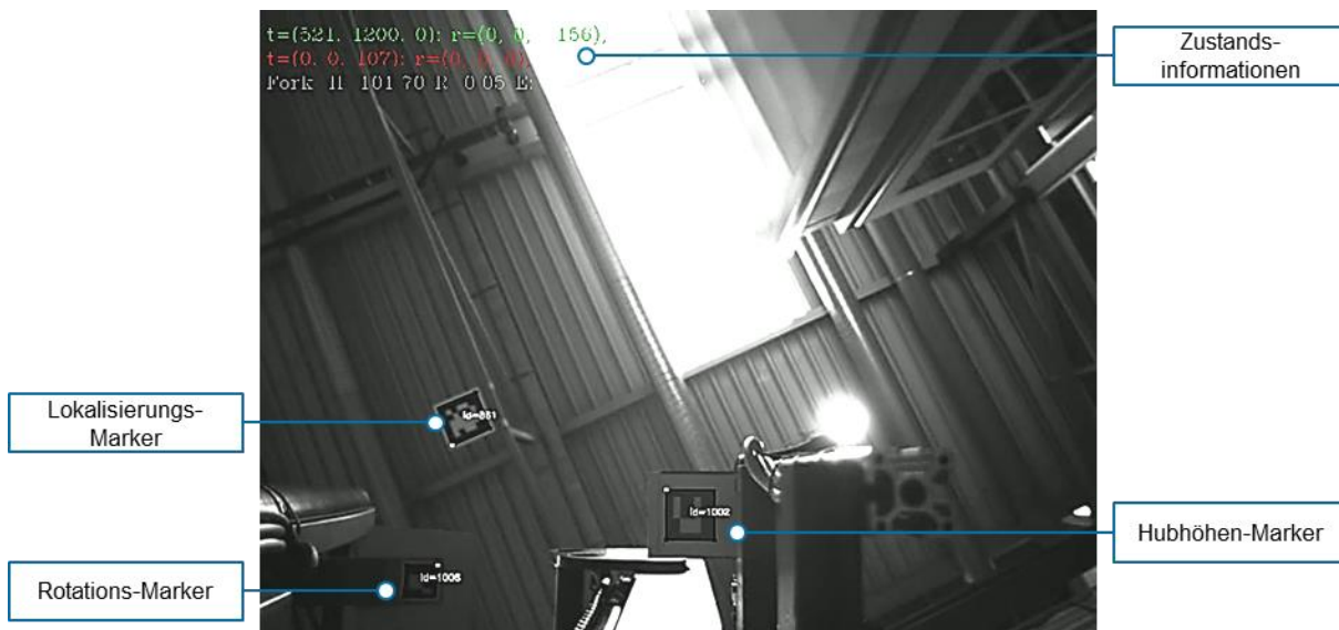
Abbildung 8-1: Beispielszene des Funktionsdemonstrators für die Bilderfassung zur funktionsintegrierten Lokalisierung und Hubhöhen-Bestimmung
