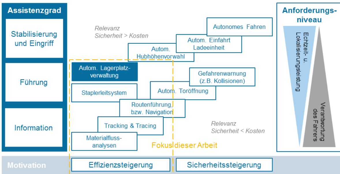
Abbildung 3-6: Übersicht zu Anwendungen zur Flurförderzeuglokalisierung (nach [LIN-2009])
