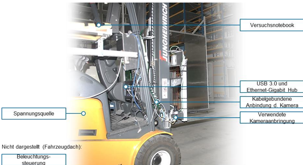
Abbildung 7-3: Vorbereitung des Versuchsstaplers für den Betrieb einer Kamera
