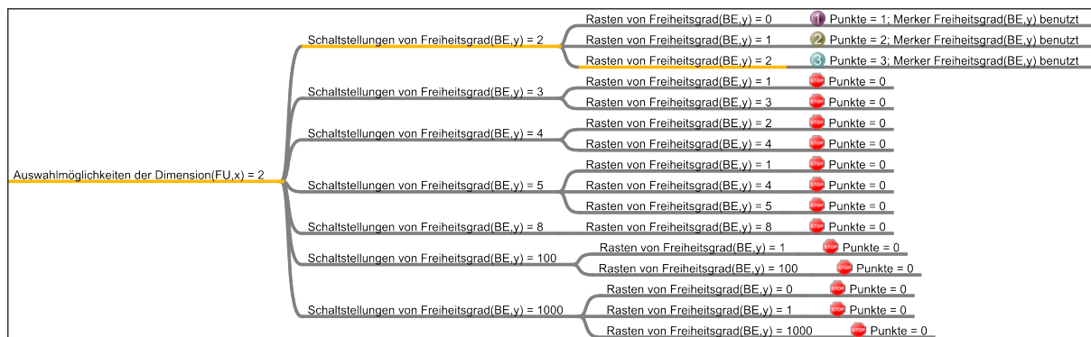
Abbildung 40: Ausschnitt aus dem Entscheidungsbaum für den Vergleich der Dimensionen der Nutzerfunktion mit den Freiheitsgraden des Bedienelements. Zu sehen sind die letzten drei von acht Entscheidungsebenen. Die im Beispiel unten durchlaufenen Zweige sind in diesen Ebenen orange markiert.
