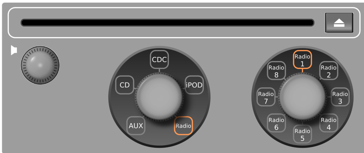
Abbildung 81: Bedienfeld der Gruppe „Audio“ mit den Funktionen Lautstärke, CD-Auswurf, Audioquellenwahl und der Auswahl aus hier acht gespeicherten Sendern.
