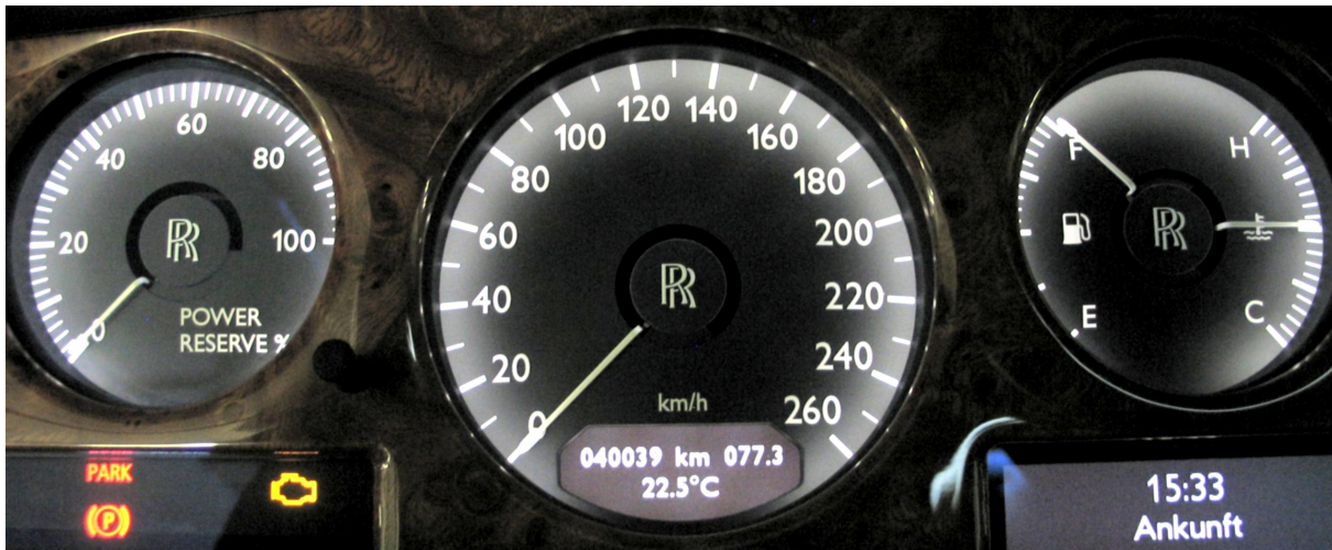
Abbildung 52: Analoge und digitale Anzeigen in der Instrumentenkombination eines Kraftfahrzeugs
