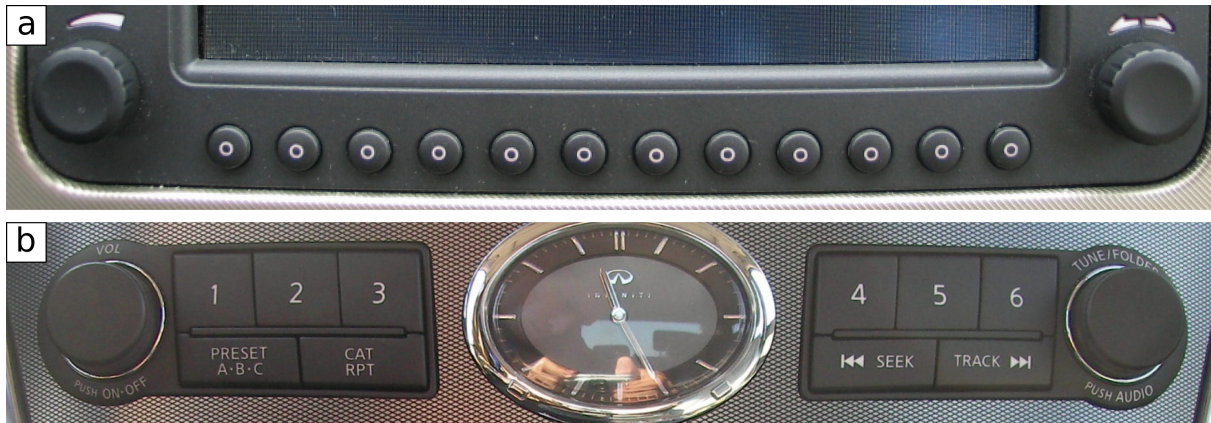
Abbildung 29: Symmetrische Drehsteller an Autoradios: a: Alfa Romeo 159 (seit 2005), b: Infiniti M (seit 2006, US-Modell)
