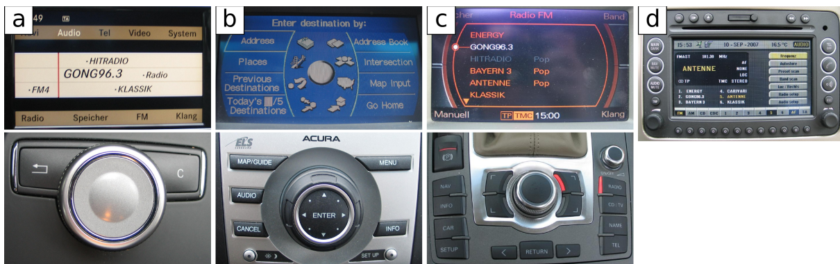
Abbildung 45: Bildschirmsysteme von Mercedes (a), Acura (b), Audi (c) und Alfa Romeo (d)
