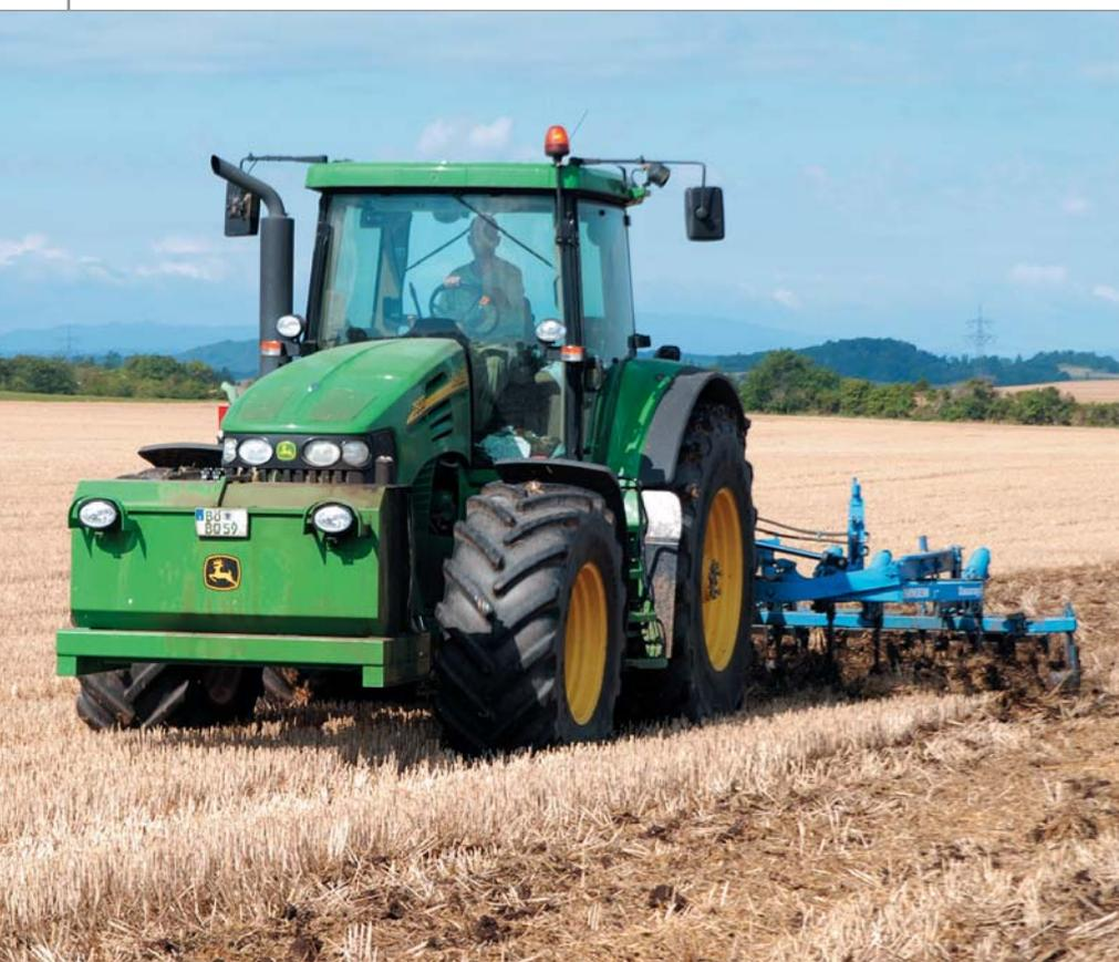
Только «правильное давление» в шинах даст возможность передать больше тягового усилия на почву при работе на низких скоростях.
