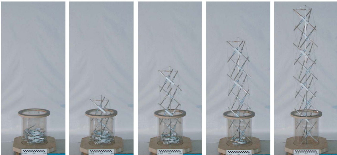
Abb. 40: Tensegritysystem mit Klappgelenken in den Druckstäben [82]
