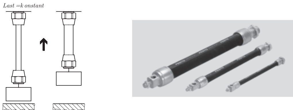
Abb. 52: Pneumatischer Muskel als Zugaktor der Firma FESTO [24]
