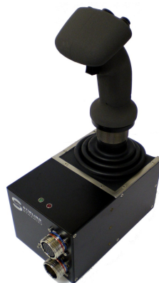
Abbildung 9.6: Zweiachsiges, aktives Stellteil von Stirling Dynamics (entnommen aus Science City, 2013)
