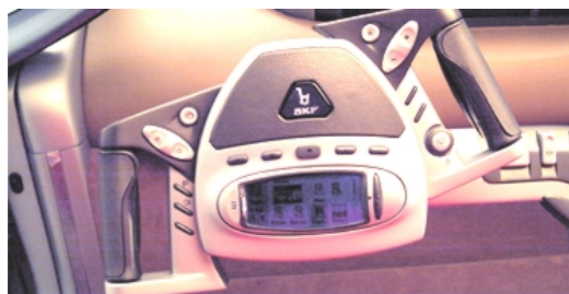
Abbildung 7.7: Filo-Bedienelement für die Längs- und Querführung eines Kraftfahrzeugs (entnommen aus Huang, 2004)
