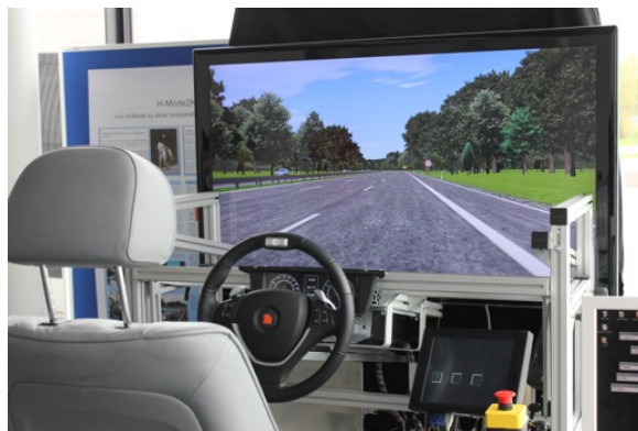
Abbildung 8.1: Fahrsimulator des Lehrstuhls für Ergonomie
