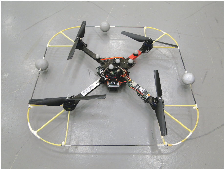
Abbildung 6.1.: Quadrokopter „Hummingbird“ der Firma Ascending Technologies GmbH 1 , bestückt mit reflektierenden Markierungspunkten, welche die Erkennung durch das Kamerasystem ermöglichen.
