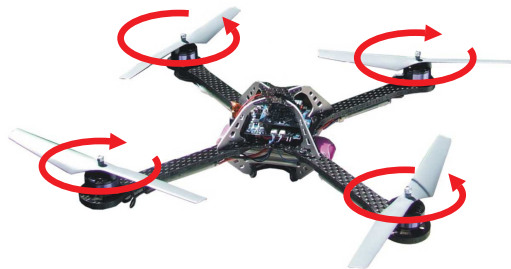
Abbildung 2.1.: Quadropters "Hummingbird" der Ascending Technologies GmbH mit dargelegter Drehrichtung der Rotoren.
