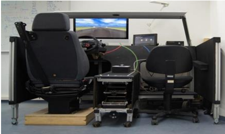
Abbildung 6-3: Mit den Bedienelementen eines Automotive-Premiumherstellers ausgerüsteter Simulator (Quelle: Eigenes Foto)
