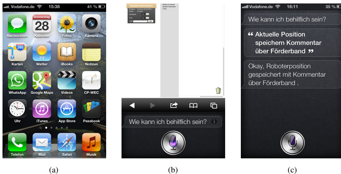
Abbildung 6.18: CustomPacker-WEC-Applikation - Die Schritte für die sprachbasierte Programmierung: (a) Startbildschirm mit CustomPacker-WEC-Applikation (b) CustomPacker-WEC-Applikation mit Siri (c) Erkannte Eingabe mit Systemrückmeldung
