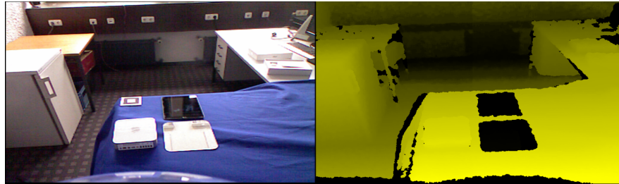
Abbildung 6.15: Spiegelungen bei Objekten (iPad, Mac-Mini, Spiegel): Links RGB-Bild, rechts Tiefenbild
