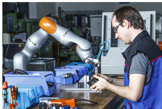
Abbildung 2.6: Sensorgesteuerte Fertigung mit dem Fertigungsassistent [55]
