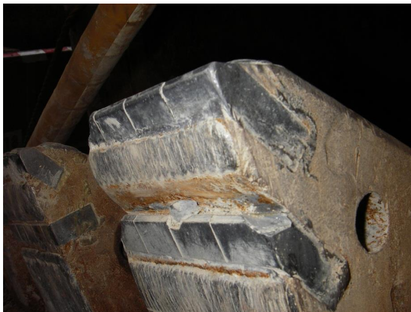
Abb. 57: Blick auf die Rückenfläche eines Schälmessers nach dem Vortrieb in steinigem Kies. An den Hartmetalleinsätzen in der Rückenfläche sind zwei Sprödbrüche erkennbar, wobei beim linken der beiden Brüche das Bruchstück noch am Grundkörper anhaftet. Der Hartauftrag in der Rückenfläche zeigt daneben die für den Primärverschleiß typischen, parallel verlaufenden, Kratzer in Schneidrichtung des Schälmessers (Kap. 5.3.4.1).
