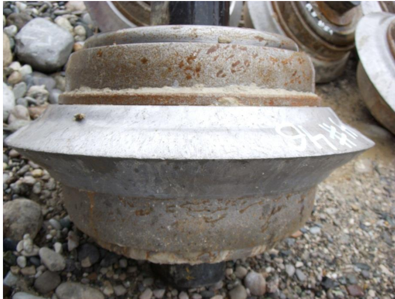
Abb. 39: Schneidrolle nach dem Einsatz in dicht gelagerten, sandigen Kiesen. Die Schneide des Schneidrings ist gegenüber der ursprünglichen Form deutlich zugespitzt. Auf der hell scheinenden Flanke des Schneidrings oberhalb der Bildmitte sind radial verlaufende Kratzer zu erkennen.
