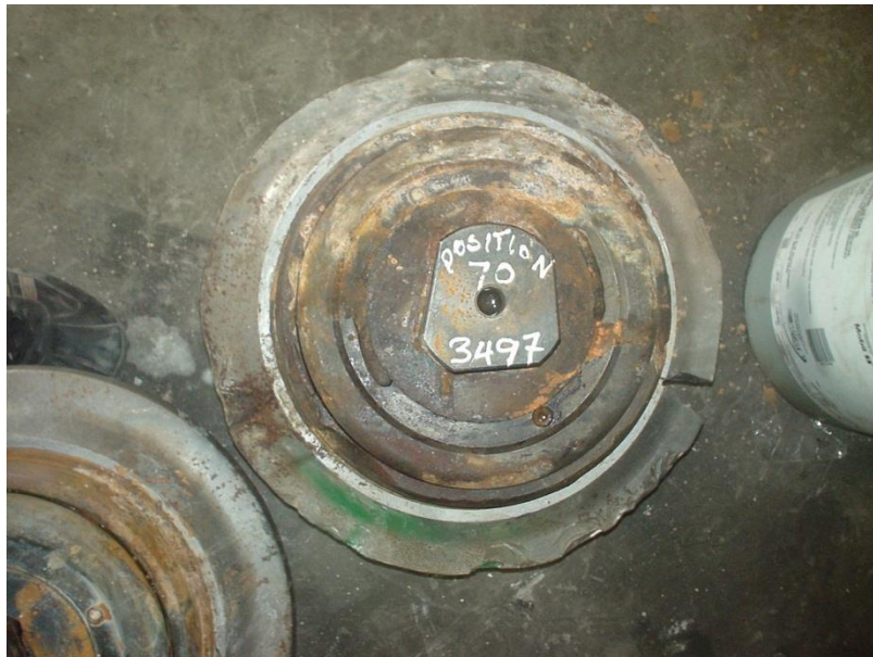
Abb. 45: 1-Ring Schneidrolle mit gerissenem Schneidring und weiteren Abplatzungen am Schneidring nach Durchfahren eines Bohrpfahls mit Stahlbewehrung.
