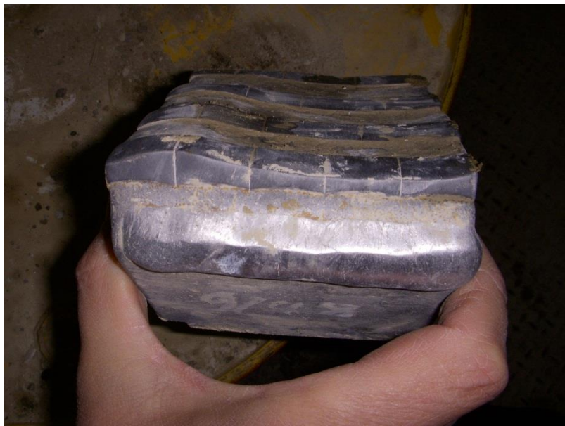
Abb. 55: Blick auf die Front- und Rückenfläche eines verschlissenen Schälmessers nach dem Bodenabbau mit vorlaufenden Schneidrollen in sandigen Kiesen. Die Rückenfläche zeigt auf der linken Seite eine leichte Aufwölbung. Hier wurde das Schälmesser durch die vorlaufende Schneidrolle geschützt. Auf den Hartmetalleinsätzen in der Rückenfläche und der Schneide sind Kratzer in Schneidrichtung des Schälmessers erkennbar. Die Frontfläche des Schälmessers zeigt unterhalb der Schneide deutlichen Abrieb. (Herrenknecht AG)
