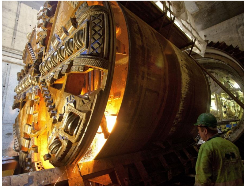
Abb. 6: Schneidrad mit umlaufender Felge. Das Schneidrad ist außenliegend bzw. vor der Schildschneide angebracht. (Herrenknecht AG)
