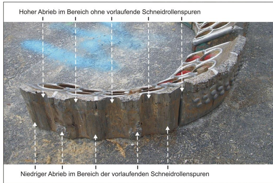
Abb. 60: Blick auf die Rückenfläche eines Räumerssegments nach dem Vortrieb in schluffigen Sanden. Der Abrieb in der Rückenfläche ist im Bereich der vorlaufenden Schneidrollenspuren deutlich niedriger als in den dazwischen liegenden Bereichen ohne vorlaufende Schneidrollenspuren. (Herrenknecht AG; verändert)
