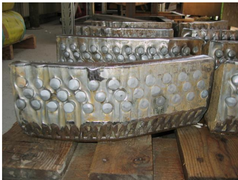
Abb. 61: Blick auf die Rückenfläche eines Räumersegments nach dem Vortrieb in sandigen Schluffen. Der rechte Teil der Rückenfläche ist durch Primärverschleiß gleichmäßig eingeebnet. Zwischen den Hartmetalleinsätzen und dem Grundkörper ist hier kein Unterschied erkennbar. Im linken Teil der Rückenfläche sind die Hartmetalleinsätze in der Rückenfläche durch Sekundärverschleiß freigelegt. Dabei sind deutliche Spülmarken zwischen den Einsätzen erkennbar. (Herrenknecht AG)
