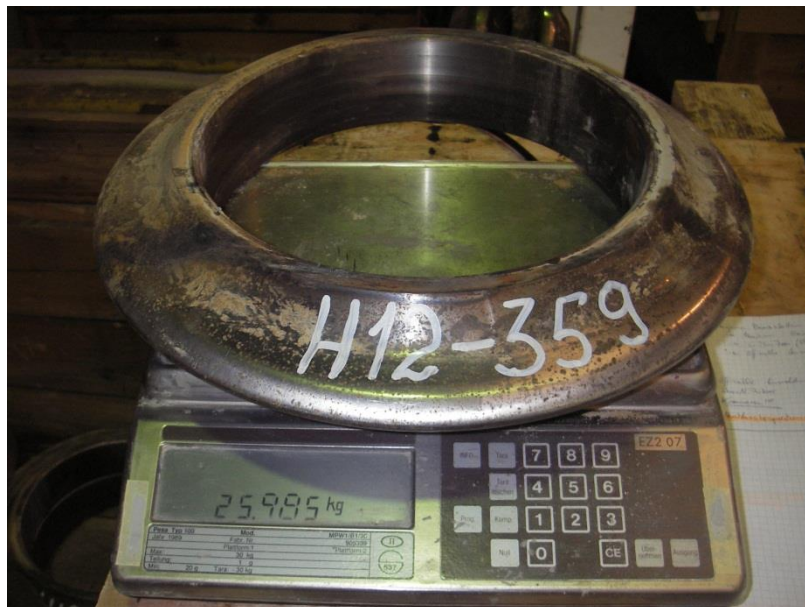
Abb. 65: Wägung eines Schneidrings mit der Laborwaage auf +/- 1 g genau.
