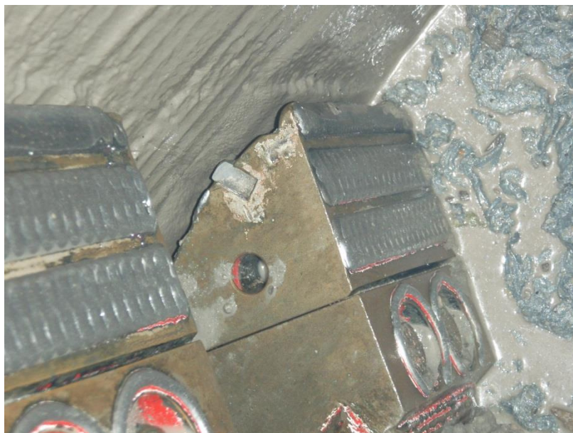
Abb. 53: Blick durch eine Schneidradöffnung auf zwei Schälmesser und die Ortsbrust in tonigen Schluffen. Die Ortsbrust ist glatt und zeichnet zum Teil detailliert die Form der Schälmesser nach. (Herrenknecht AG)
