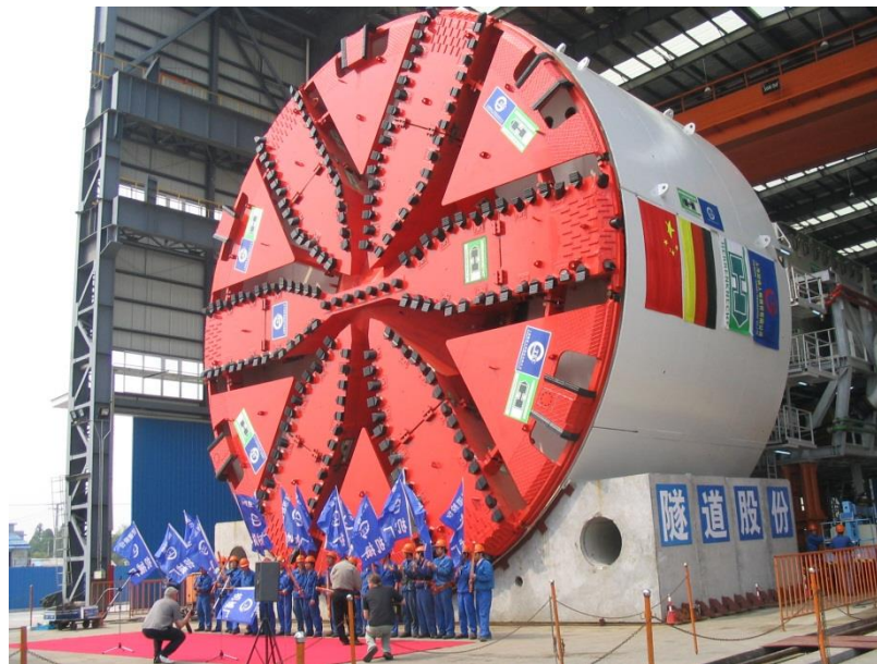
Abb. 7: Außenliegendes Felgenschneidrad mit begehbaren Armen für drucklosen Werkzeugwechsel. (Herrenknecht AG)
