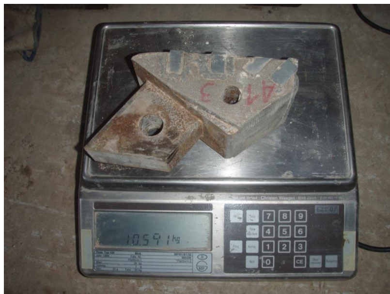
Abb. 69: Wägung eines Schälmessers mit der Laborwaage auf +/- 1 g genau.
