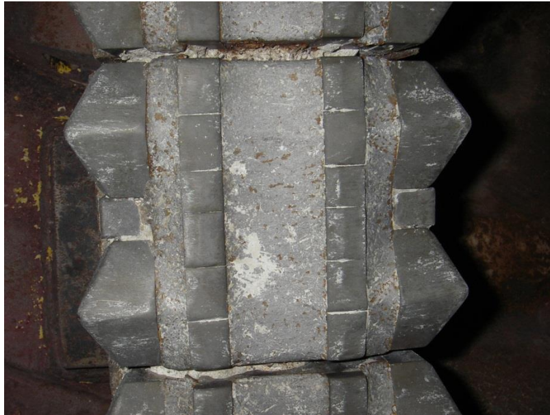
Abb. 47: Blick auf die Rückenfläche eines Stichels. Sowohl am Grundkörper als auch an den Hartmetalleinsätzen sind Kratzer parallel zur Schneidrichtung des Stichels zu erkennen.
