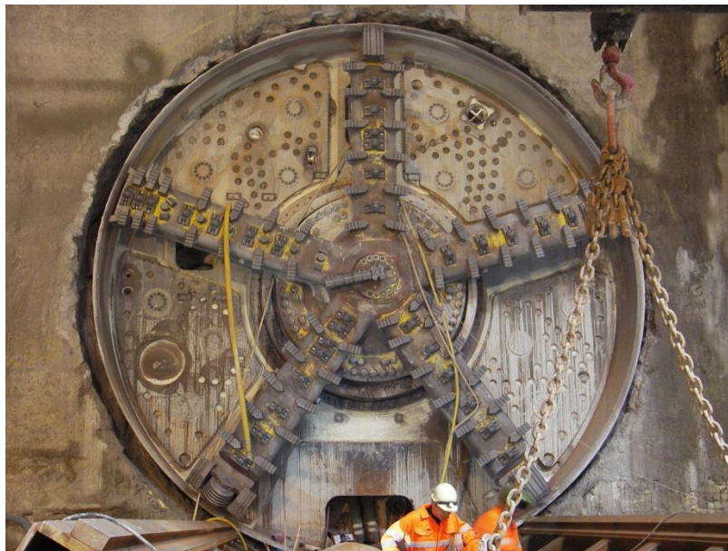
Abb. 5: Sternförmiges Speicherschneidrad ohne umlaufende Felge. Das Schneidrad ist im Schild innenliegend angebracht. Der Antrieb ist verschiebbar gelagert, sodass das Schneidrad auch vor das Schild ausgefahren werden kann. Der Bohrdurchmesser kann dann durch hydraulisch ausfahrbare Überscheider an den Armen erhöht werden.
