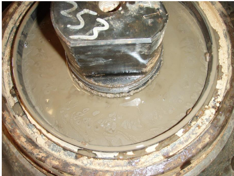
Abb. 41: Geöffnete Schneidrolle mit verschlissener Gleitringdichtung. Die Lagerkammer ist mit Bentonitsuspension gefüllt. (Herrenknecht AG)
