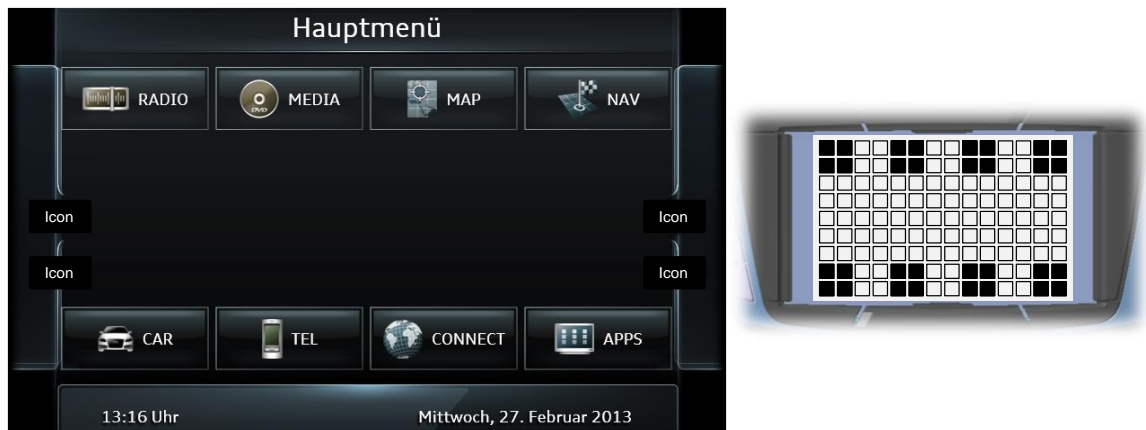
Abbildung 5-9: Hauptmenüsreen mit acht Hauptgruppen und die zugehörige Darstellung der bedienbaren Elemente auf dem haptischen Touchpad
