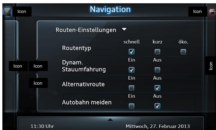
Abbildung 5-15: Rechtes Seitenmenü der Hauptgruppe Navigation (NAV) mit geöffneter Drop-Down Funktion „Routen-Einstellungen“ und den untergeordneten als Flip-Flop Schalter umgesetzten Optionen
