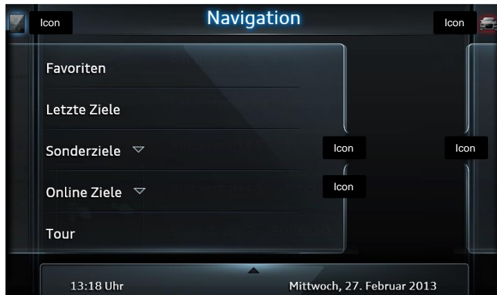
Abbildung 5-13: Linkes Seitenmenü (File-Menü) der Hauptgruppe Navigation (NAV) mit zwei Drop-Down Funktionen (angedeutet durch den nach unten weisenden Pfeil)
