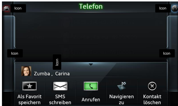
Abbildung 5-16: Aktionsmenü der Hauptgruppe Telefon (TEL) mit fünf aufgabenorientiert angebotenen Funktionen bei einem ausgewähltem Listeneintrag (Zumba, Carina)
