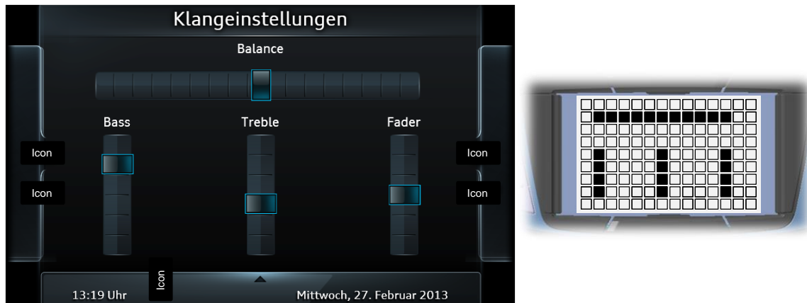
Abbildung 5-18: Equalizer-Screen der Klangeinstellungen (Tone-Menü) mit als Slider ausgeführten Funktionen
