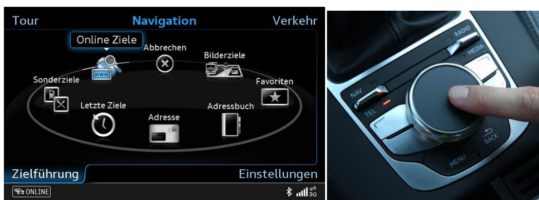
Abbildung 6-1: Menüscreen der Hauptgruppe Navigation (Audi, 2013) und Bedienelement (Auto Zeitung, 2013) des Dreh-Drück-Steller (DDS) Serienbedienkonzepts aus dem aktuellen Audi A3
