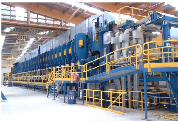
Abb. 112: Produktionsstraße für Dreischichtplatten [www.dieffenbacher.de]
