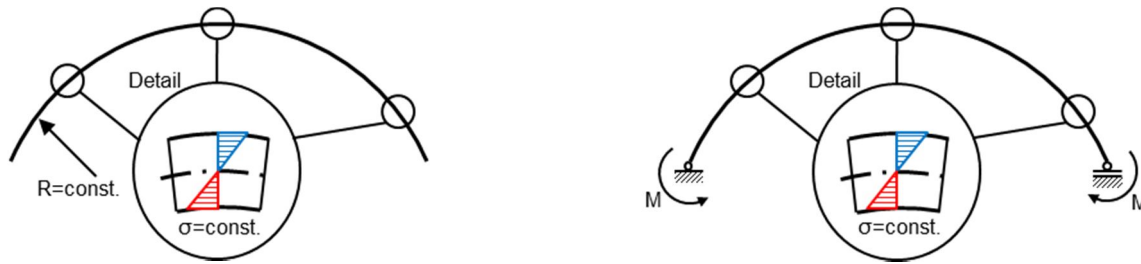
Abb. 127: Gekrümmter Stab mit Eigenspannungen und Ersatzmoment
