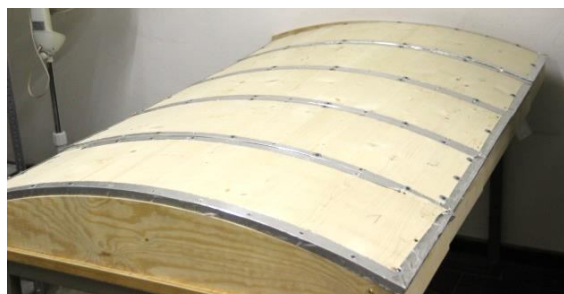
Abb. 249: Probekörper mit Aluminiumabklebung
