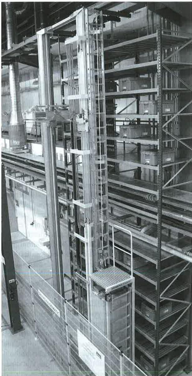
**Bild 1** Automatisches Kleinteilelager in der Versuchshalle des Lehrstuhls (fml).
