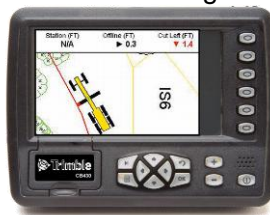
Abbildung 3.4-20: Beispiel für einen Universalcontroller (Trimble CB430, Einsatz am Grader)
