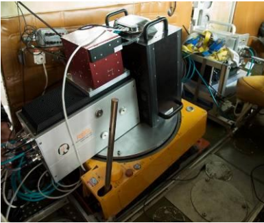
Abbildung 3.1-31. Links: Flugzeugeinbau des MFC-5 und eines Laser-scanners. Rechts: 3D-Trassenabschnitt aus Airborne Laserscanning
