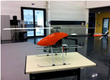
Abbildung 3.2-35: Elektro-Helikopter für Sensoren bis 2.500g.
