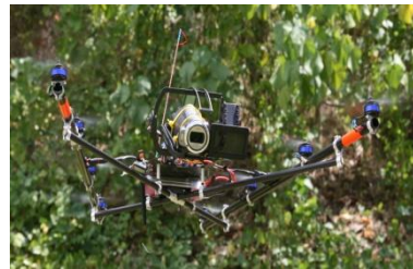
Abbildung 3.2-34: Falcon 8 für leichte Kameras bis 350 g
