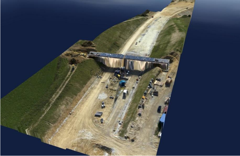
Abbildung 3.2-40: B15N 3D-Baustellenmodell Die Daten können im PLY Format oder als Punktwolke im PTS-Format abgespeichert werden.
