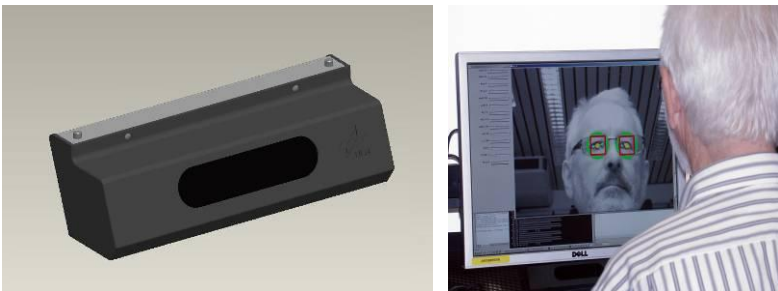
Abbildung 3.1-45: Links: Stereo Kameramodul mit integrierter IR-Beleuchtung. Rechts: Eye-Tracker
