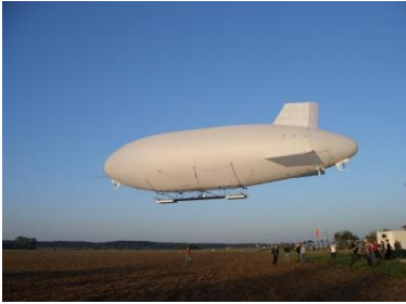
Abbildung 3.2-31: Luftschiff ALUSTRA ist mit 13 Aktoren steuerbar
