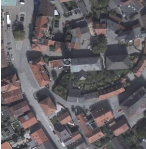
Abbildung 3.1-36. True Orthobild RGB und Höhen aus MultiCam Daten mit 5 cm Auflösung als T3C Datenobjekt
