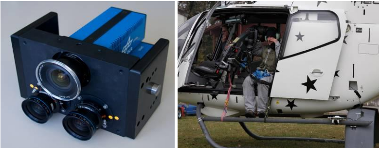
Abbildung 3.1-34. Links: MultiCam Version für Helikopter. Rechts: Helikoptereinbau für Schrägaufnahmen
