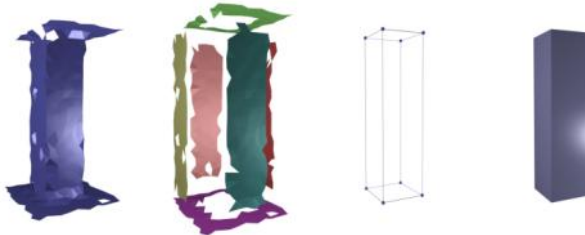
Abbildung 3.1-29: Reverse Engineering am Beispiel einer Stütze
