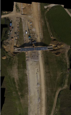
Abbildung 3.2-39: B15N True Orthobild aus 65 Octocopter Bildern
