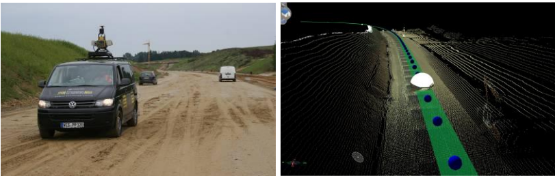
Abbildung 3.1-54: Beispiel für eine kinematische Punktaufnahme mittels des Mobile-Mapping-Systems Topcon: IP-S2
