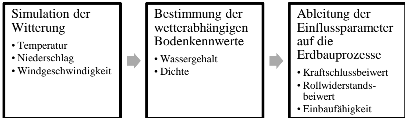
Abbildung 3.2-5: Vorgehensweise zur Abbildung des Witterungseinflusses in der Ablaufsimulation
