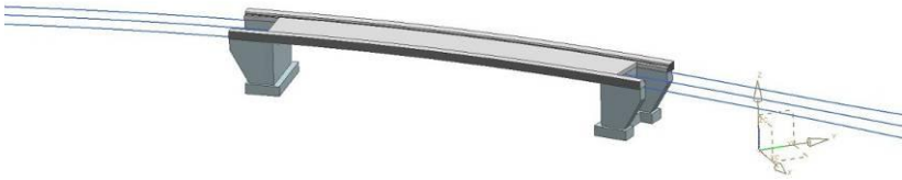
Abbildung 3.1-3: Referenzlinien des Trassenverlaufs und daran gebundene Brückegeometrie
