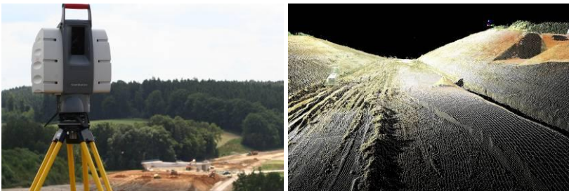
Abbildung 3.1-53: Leica Scanstation mit unvermaschter, jedoch eingefärbter Punktwolke
