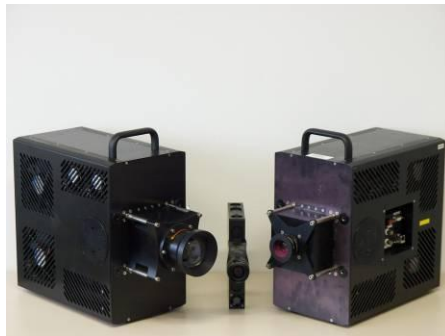
Abbildung 3.1-30: MFC Kamera-Serie, MFC-5, MFC-1, MFC-3 (von links nach rechts) mit 5, 1 und 3 CCD Zeilen Modulen
