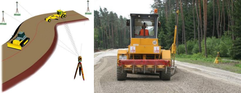
Abbildung 3.4-21: ATS-Steuerung (Prinzip und realer Einsatz, Motorgrader)
