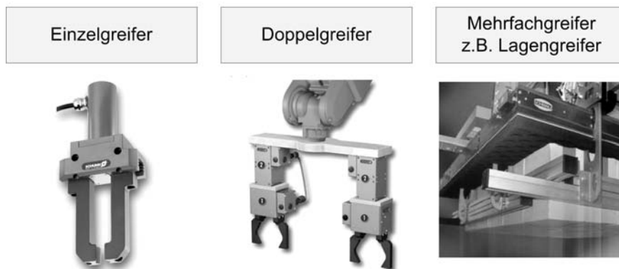
Abb. 3-13: Einzel-, Doppel- und Mehrfachgreifer [Hes-91], [Sch-06c], [Sch-06b]
