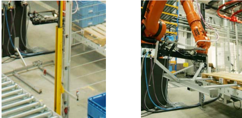
Abb. 8-20: Leerpalettengreifer (links) und Leerpalettenhandhabung (rechts)
