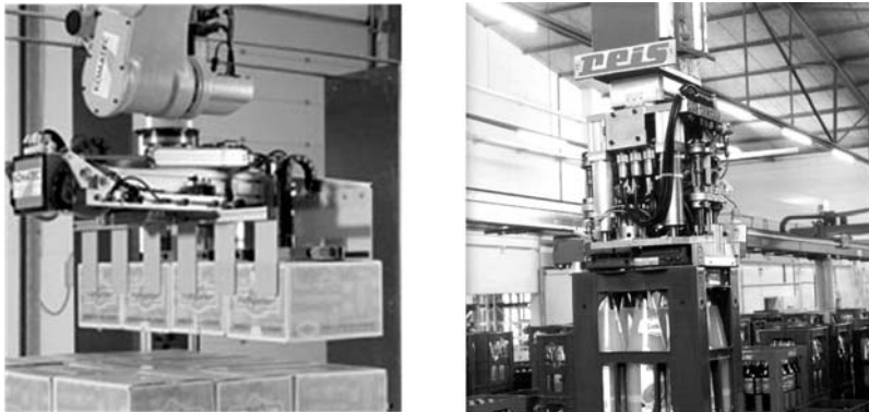
Abb. 3-16: Klemmgreifer (links) [kom-07] und Universalgetränk kastengreifer (rechts) [rei-07]
