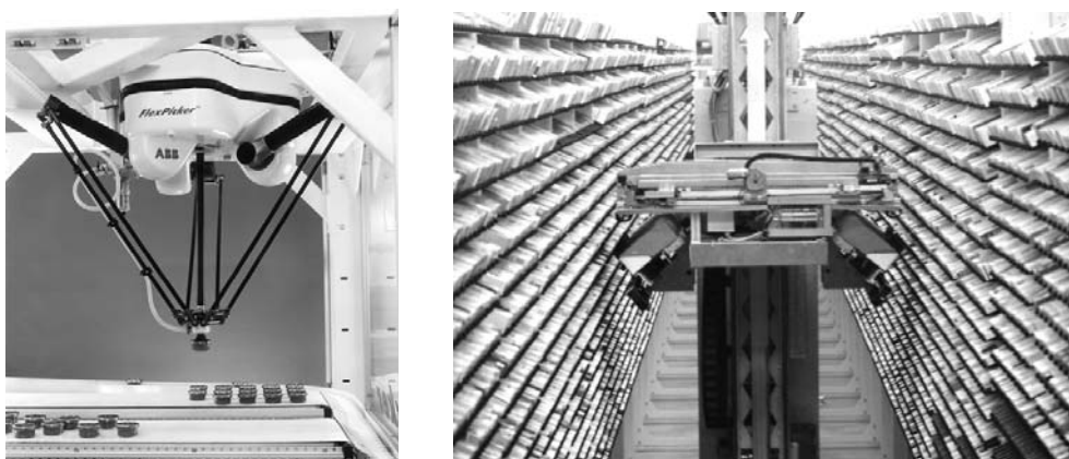
Abb. 3-27: “IRB 340 FlexPicker“ verpackt Pralinen [abb-07], Pharmakommissionierung mit Kommissionierautomat [kna-08]
