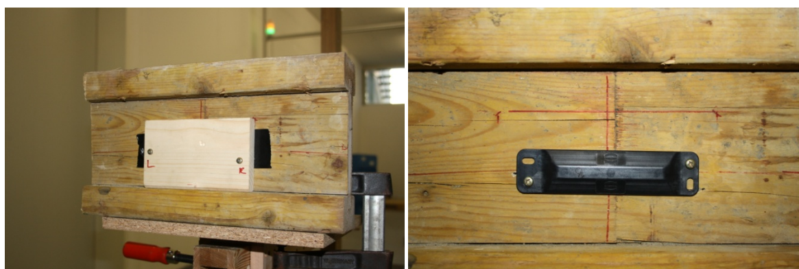
Abbildung 5-23: Kennzeichnungskonzepte für Systemschalungen aus Holz
