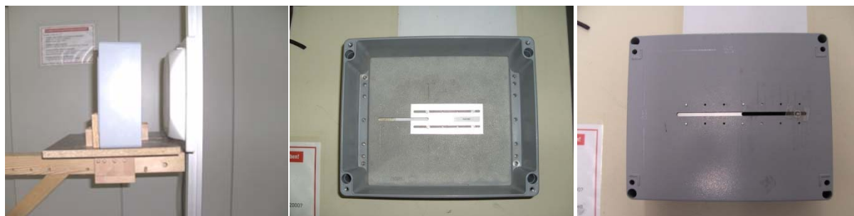
Abbildung 5-18: Schlitzkasten mit verstellbarer Schlitzlänge
