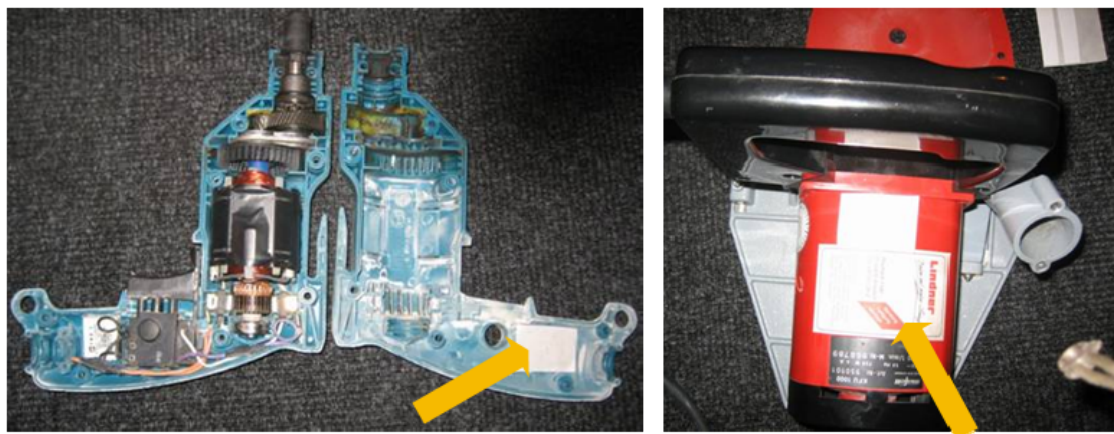
Abbildung 5-28: Kennzeichnungskonzepte für Kleingeräte
