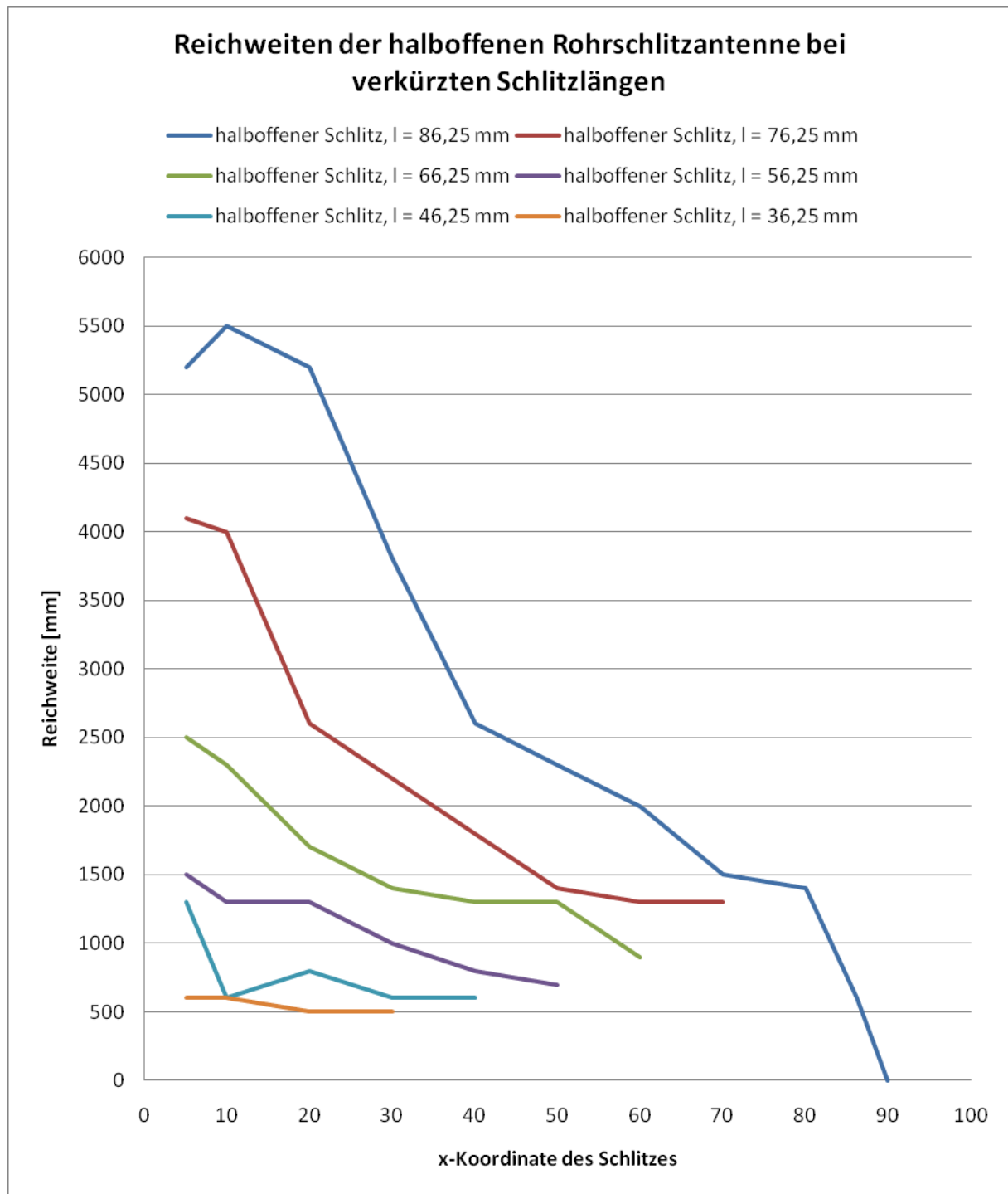
Abbildung 5-15: Lesereichweiten in Abhängigkeit von der Schlitzlänge
