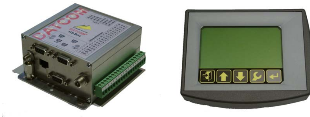
Abbildung 6-16: Bordrechner mit Touchscreen für den Testbetrieb
