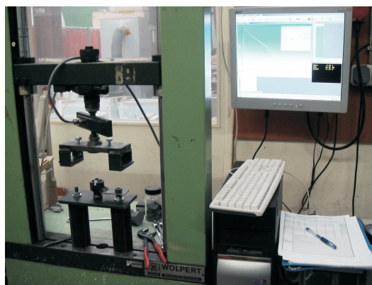
Bild K.2: Spindelgetriebene Universalprüfmaschine für die Durchführung der pull-out-Versuche
