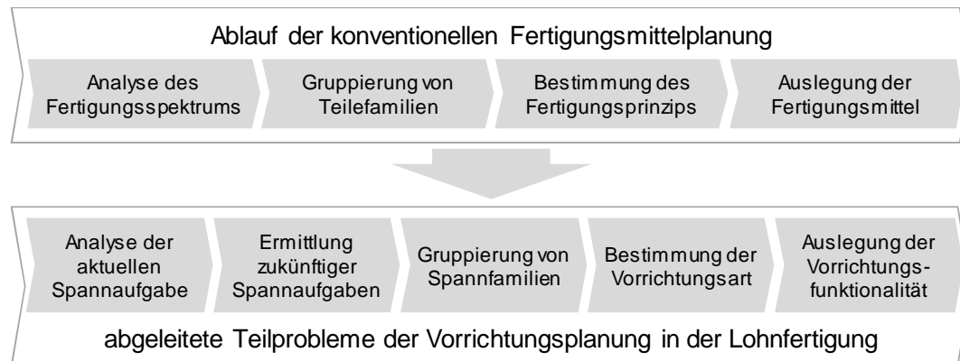
Abbildung 17: Ableitung der Aufgaben einer Methodik zur auftragsorientierten Strukturierung eines Vorrichtungssystems in der Lohnfertigung
