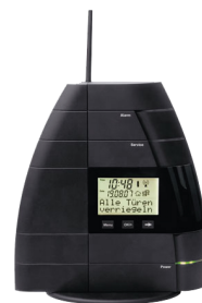
Abbildung 2.7: Zentrale Steuerung für eine HomeMatic Installation.
