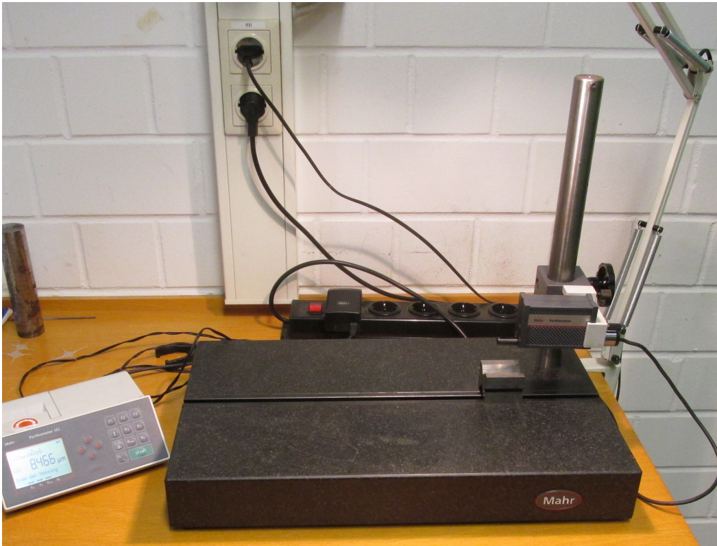
Abbildung 6.1: Perthometer der Firma Mahr für die Messung verschiedener Kenngrößen der Oberflächenrauheit.
