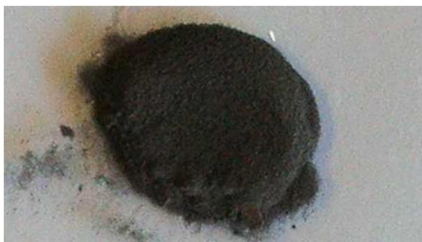
**Abbildung 46:** Zersetzter schwarzer Nickel-Katalysator auf vorbehandeltem Kieselgel.<sup>[21]</sup>
