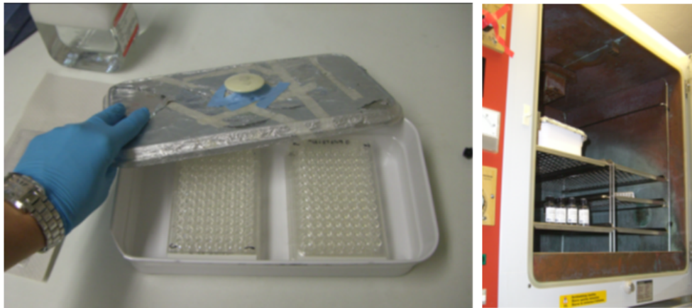
Abbildung 10 ELISAplatten mit Sealer verschlossen zum Inkubieren (links); Inkubator mit Inkubationsbox (rechts)
