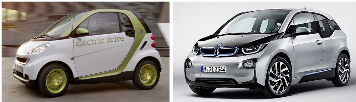
a) Abbildung 2-14 a) Conversion Design: Smart ed b) Purpose Design: BMW i3 aus [Sma13] und [BMW13a]
