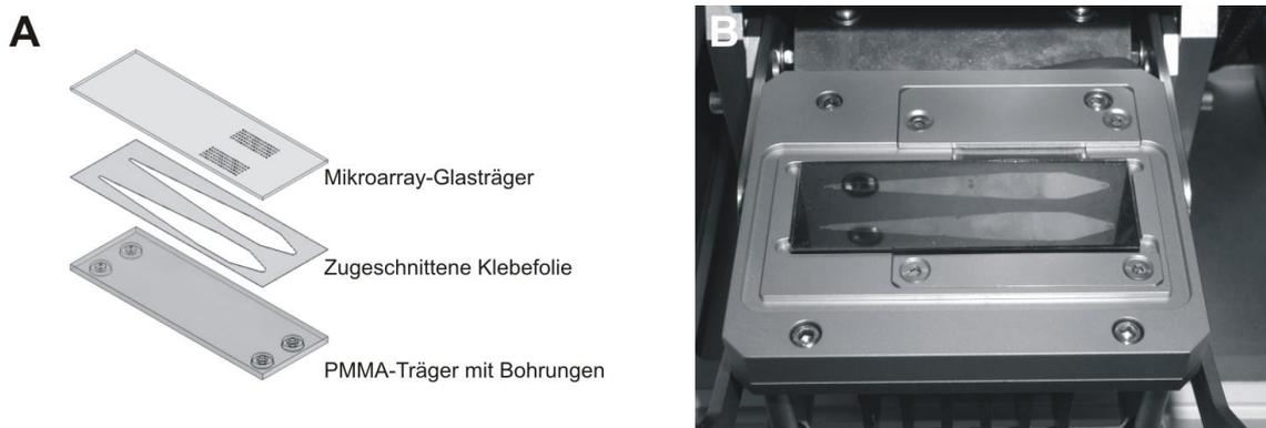
**Abbildung 6.2:** Aufbau des dreiteiligen gekapselten Durchfluss-Chips mit zwei Messkanälen (a), Schublade für die fluidische Anbindung des Durchfluss-Chips an das Kapillarsystem des MCR 3 (b).
