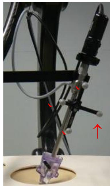
Abbildung 8: 0°-Optik am Arm des SOLOASSIST mit 4 silbergrauen, kugelförmigen NDI-Markern (Pfeile)
