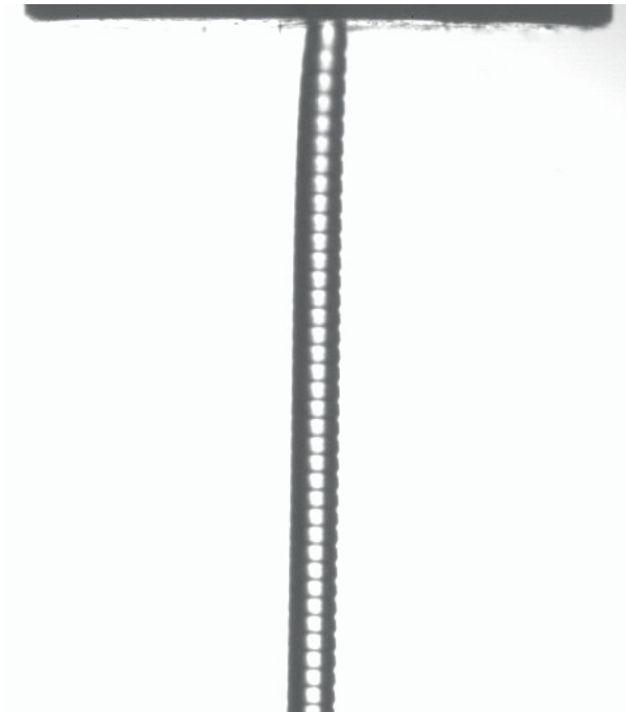
Abbildung 11.3: Standbild der Extrusion eines Kunststoffstrangs mit Strukturierung aufgrund des Öffnens und Schließens der Austrittsöffnung, entnommen aus einer Aufnahme mit einer Hochgeschwindigkeitskamera.
