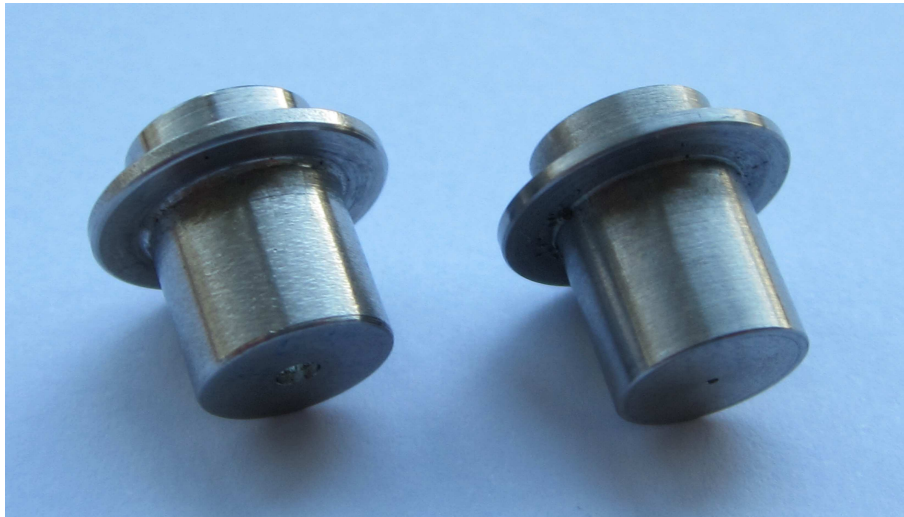
Abbildung 8.12: Beispiele für Düsen. Bei gleicher Grundgeometrie kann der Düsenkanal variiert werden. Links ist eine Düse mit großem Durchmesser von 2 mm, rechts mit deutlich kleinerem Durchmesser von 100 \mu\text{m} zu sehen.
