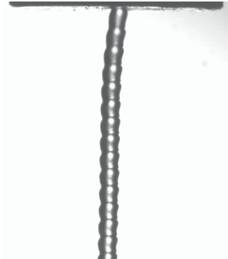
Abbildung 11.1: Standbild der Extrusion eines Kunststoffstrangs mit Strukturierung aufgrund des Öffnens und Schließens der Austrittsöffnung, entnommen aus einer Aufnahme mit einer Hochgeschwindigkeitskamera.
