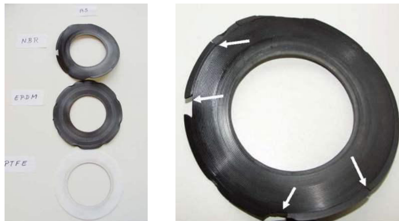
Abbildung 6.34: Dichtungswerkstoffproben von Position A5 und eine Detailaufnahme der NBR-Dichtung (rechts) [43]
