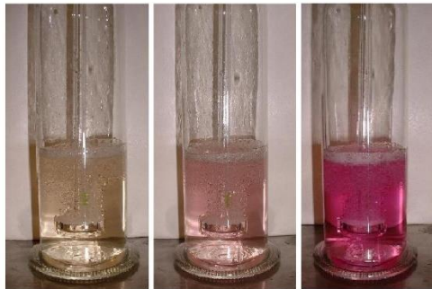
Abbildung 3 - 18: Farbentwicklung nach Einleiten von Spuren an \text{NO}_2 in die Absorptionslösung nach Saltzman.
