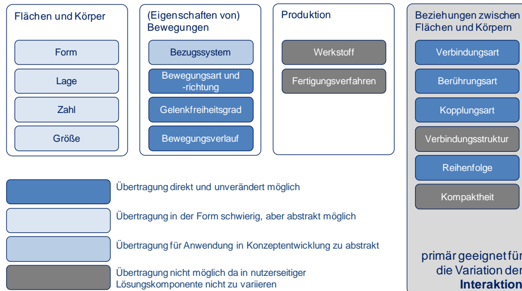
Bild 6-8: Übertragung von Variationsparametern technischer Produktlösungskomponenten nach [PONN & LINDEMANN 2011, S. 399] auf die Anwendung auf nutzerseitige Interaktionslösungskomponenten – Übertragungsmöglichkeiten sind entsprechend farblich gekennzeichnet.
