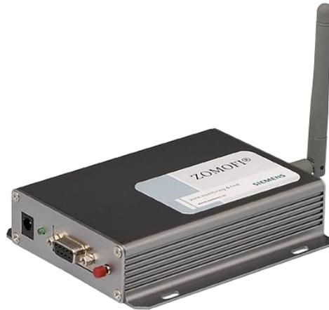
Abb. 13: RFID-Sektor-Controller (Länge: 15 cm, Breite: 8 cm, Höhe: 2 cm, ZOMOFI Network Controller, Albis Technologies Ltd., Zürich, Switzerland)
