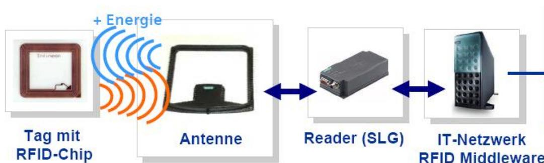
Abb. 1: Funktionsweise der Radio Frequenz Identifikation: Bild links außen zeigt den Tag mit integriertem RFID-Chip der über ein elektromagnetisches Feld mit der Antenne (Bild links Mitte) kommuniziert, welche dann die Informationen an den Reader (Bild rechts Mitte, SLG = stationäres Lesegerät) weiterleitet. Dieser Reader leitet die Daten an die weiterverarbeitende Middleware (Bild rechts außen) weiter.
